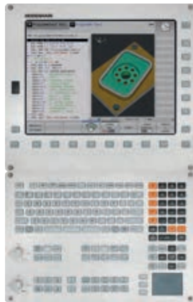
TNC 620 mit Bedientasten und Alphatastatur
