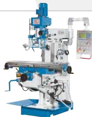
Фрезерный станок с универсальной фрезерной головкой
