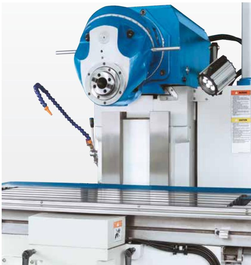
Универсальная поворотная фрезерная головка
