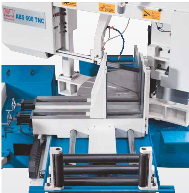
Ручная корректировка угла дуги пилы при помощи гидравлического привода (15°, 30° и 45°)
