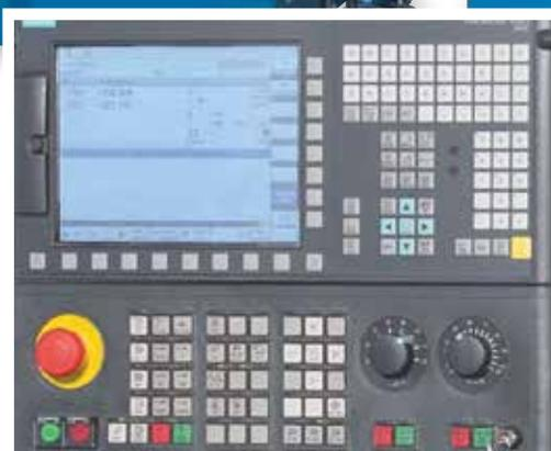
Система управления Siemens Sinumerik 828 D Basic Drehen — компактное и простое в использовании решение для токарных станков
