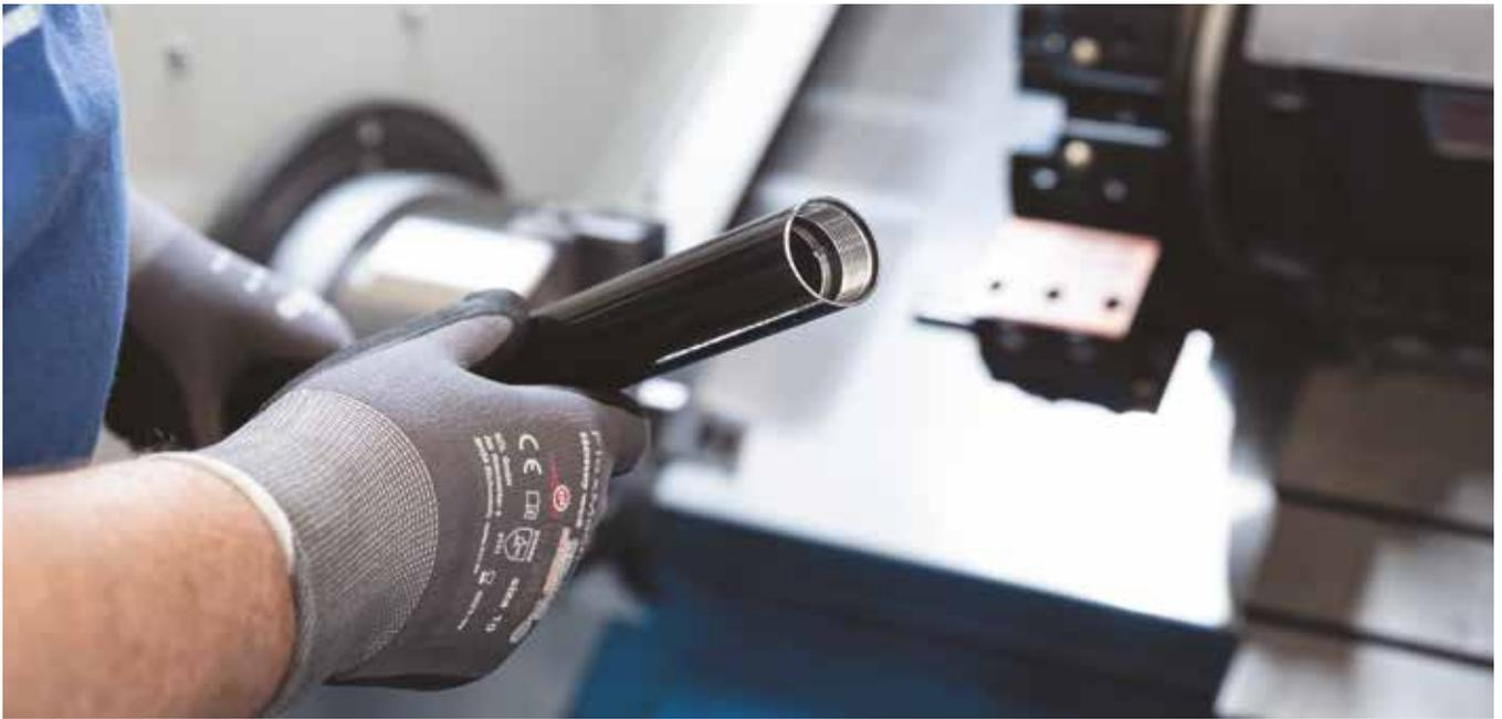
При нарезании резьбы требуется высокая точность. В дальнейшем стальные трубы соединяются с линиями спринклерной системы пожаротушения.
