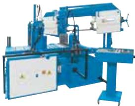
Автоматический станок с ручной настройкой угла резки: **ABS H NC**
