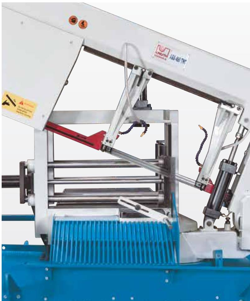
Двойные гидравлические тиски гарантируют высокую стабильность — даже при обработке пучков заготовок
