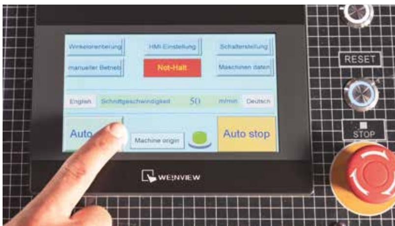
В автоматическом режиме можно программировать длину подачи, угол резки и количество резов в соответствующей конфигурации
