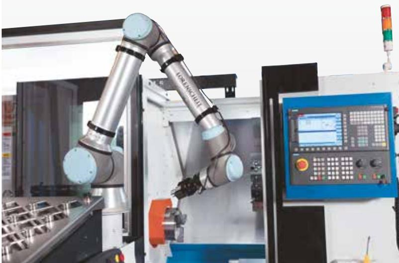
6-осевой робот-манипулятор с рабочим радиусом 1300 мм
