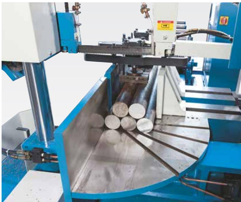
Гидравлическое устройство натяжения связки для обоих зажимных тисков в стандартной комплектации
