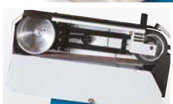
Рис. В 150 D со встроенной аспирацией
