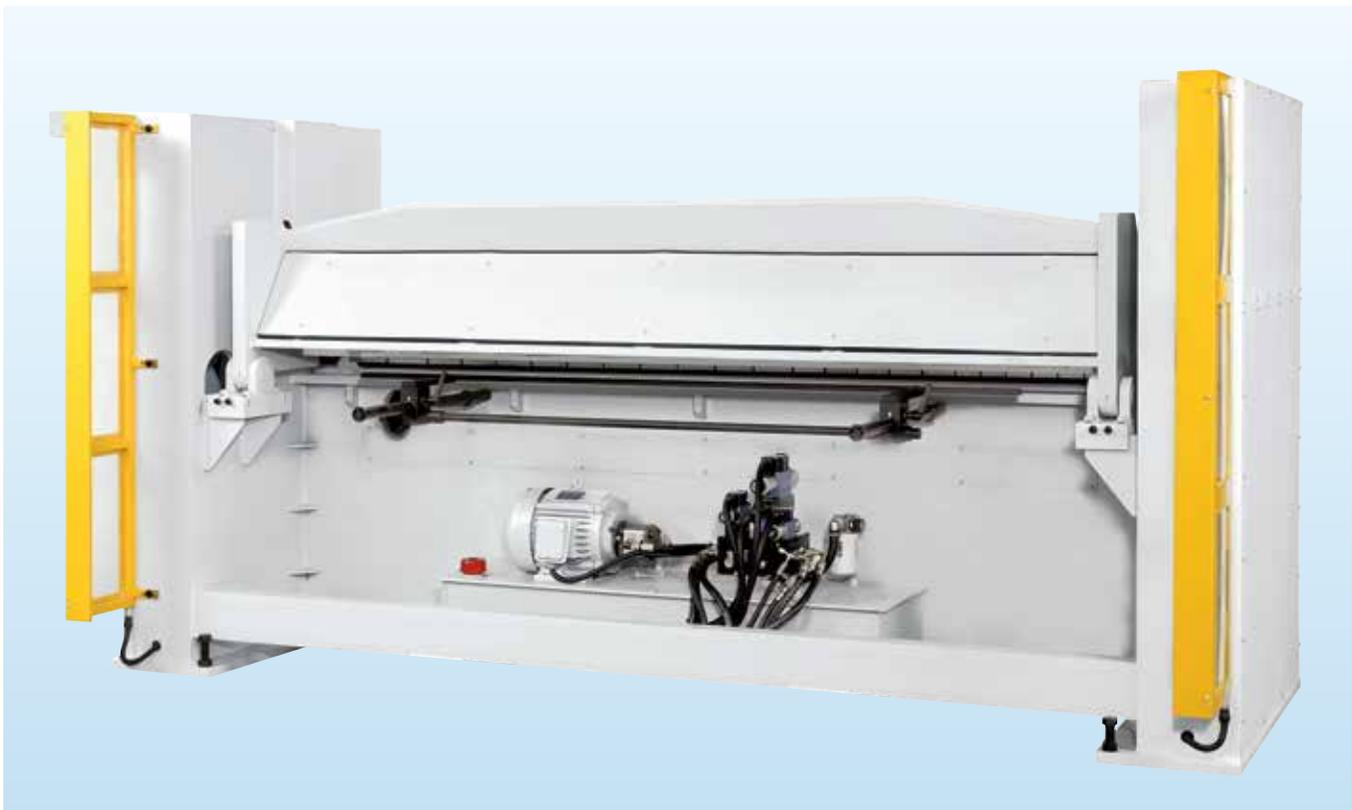
Вид станка с тыльной стороны - задний упор с ручным управлением
