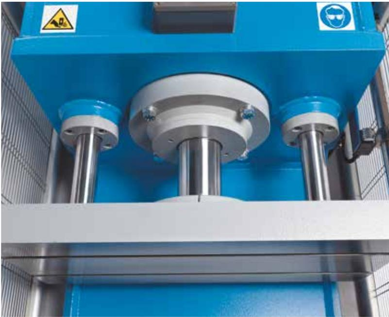
Две цилиндрические направляющие обеспечивают параллельность пластины ползуна при перемещении
