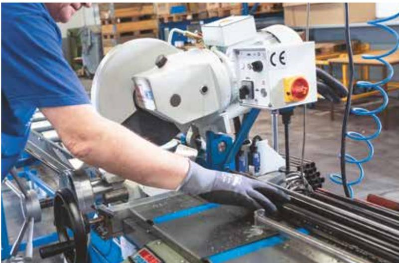
Подготовительные работы выполняются в компании Minimax полуавтоматической циркулярной пилой с пневматическим зажимом детали КНК 350 производства KNUTH. Она доводит стальные трубы до правильной длины с точностью до миллиметра.
