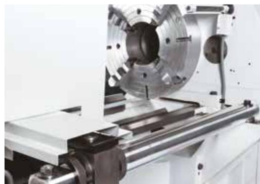
Устройство обработки конусов в серийном исполнении
