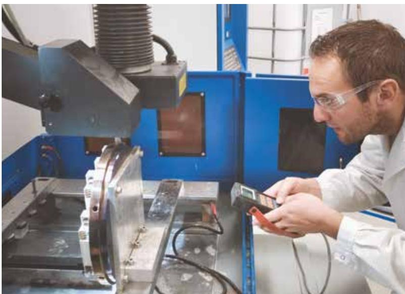
Для выполнения идеального реза задается геометрия заготовки. В данном примере выполняется обработка строительной платформы с компонентами из нержавеющей стали.
