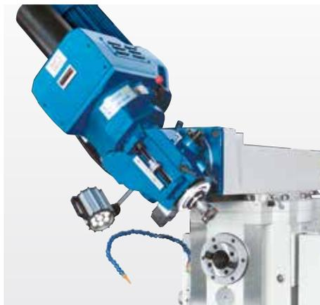
Фрезерная головка, поворачивающаяся до 45°
