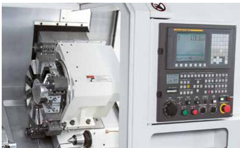
Револьверная головка с серводвигателем и двусторонним выбором инструмента
