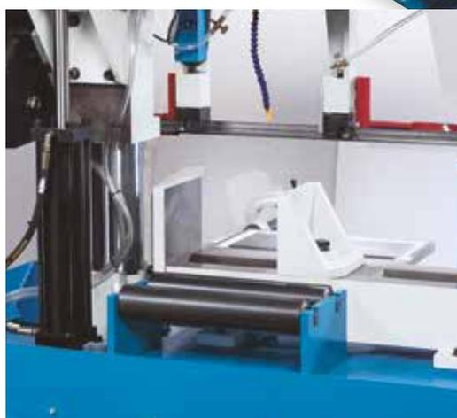
Роликовая опора для упрощения подачи материала
