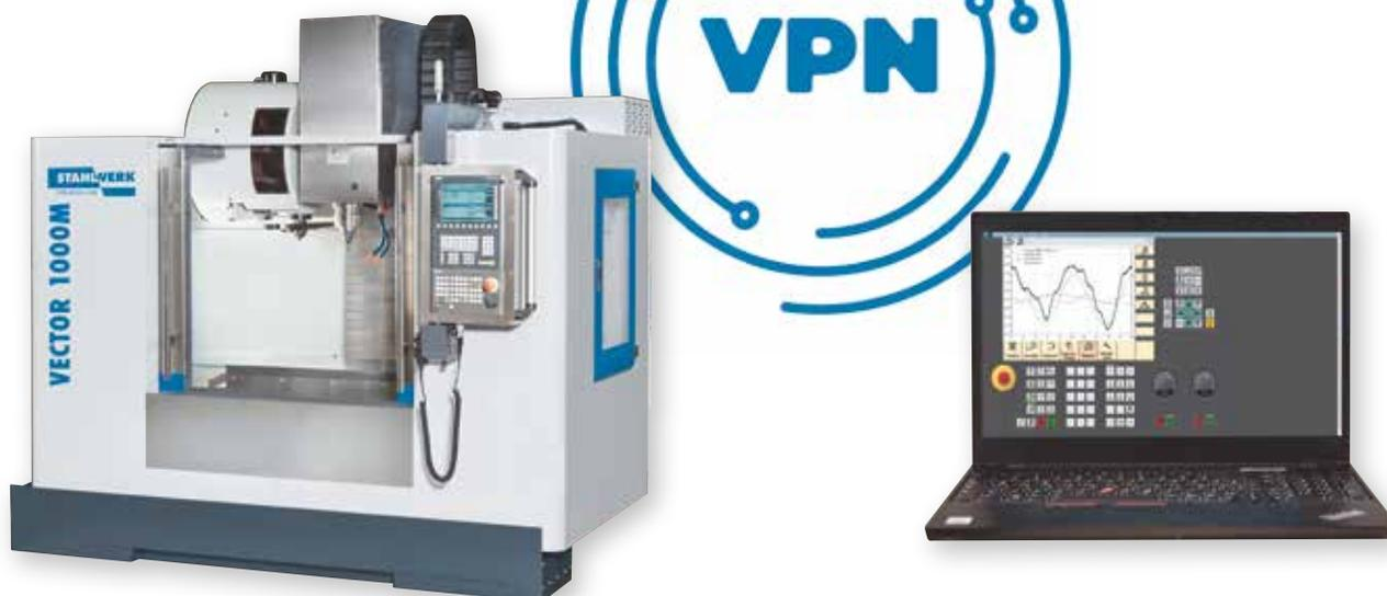
E.T. Vox - компактное соединение Вашего станка с нами, которое можно установить в распределительном шкафу станка с ЧПУ для обеспечения дистанционного доступа извне к Вашему станку посредством LAN, WI-FI или W4G.
