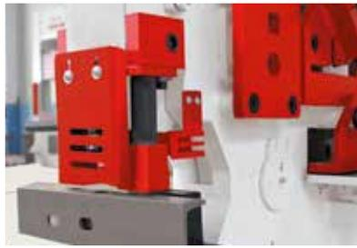
Вырубное устройство с защитным устройством
