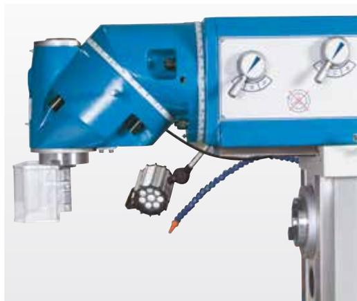
Универсальная фрезерная головка, наклоняемая в двух плоскостях
