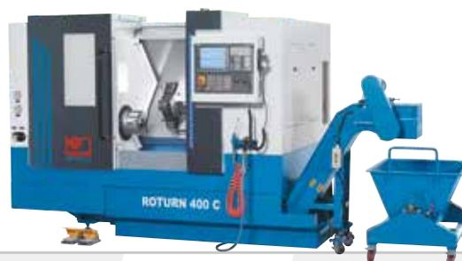
Токарный станок с наклонной станиной
