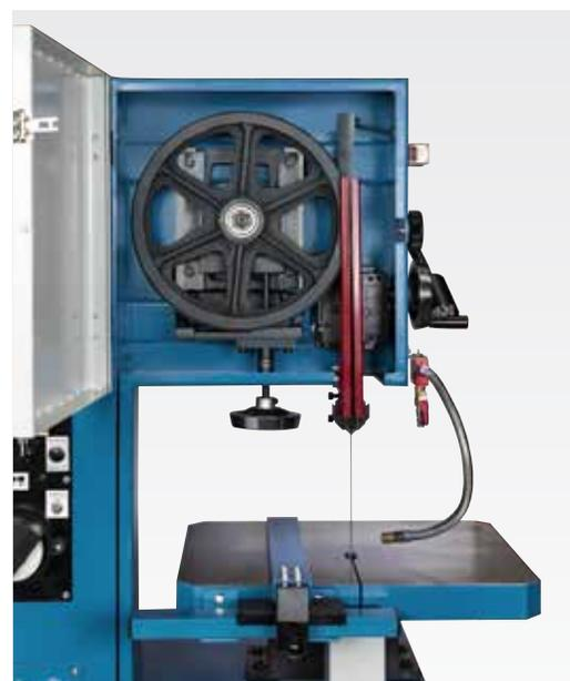
Особо стабильная направляющая ведущего колеса гарантирует его постоянное точное выравнивание и, таким образом, увеличивает производительность резки и срок службы пильного полотна
