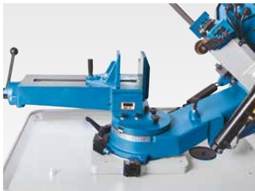
Сокращение времени простоя: угловые упоры и система быстрого зажима в тисках с точной регулировкой
