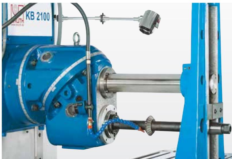
Стабильная система противодержателей для длинных фрезерных оправок
