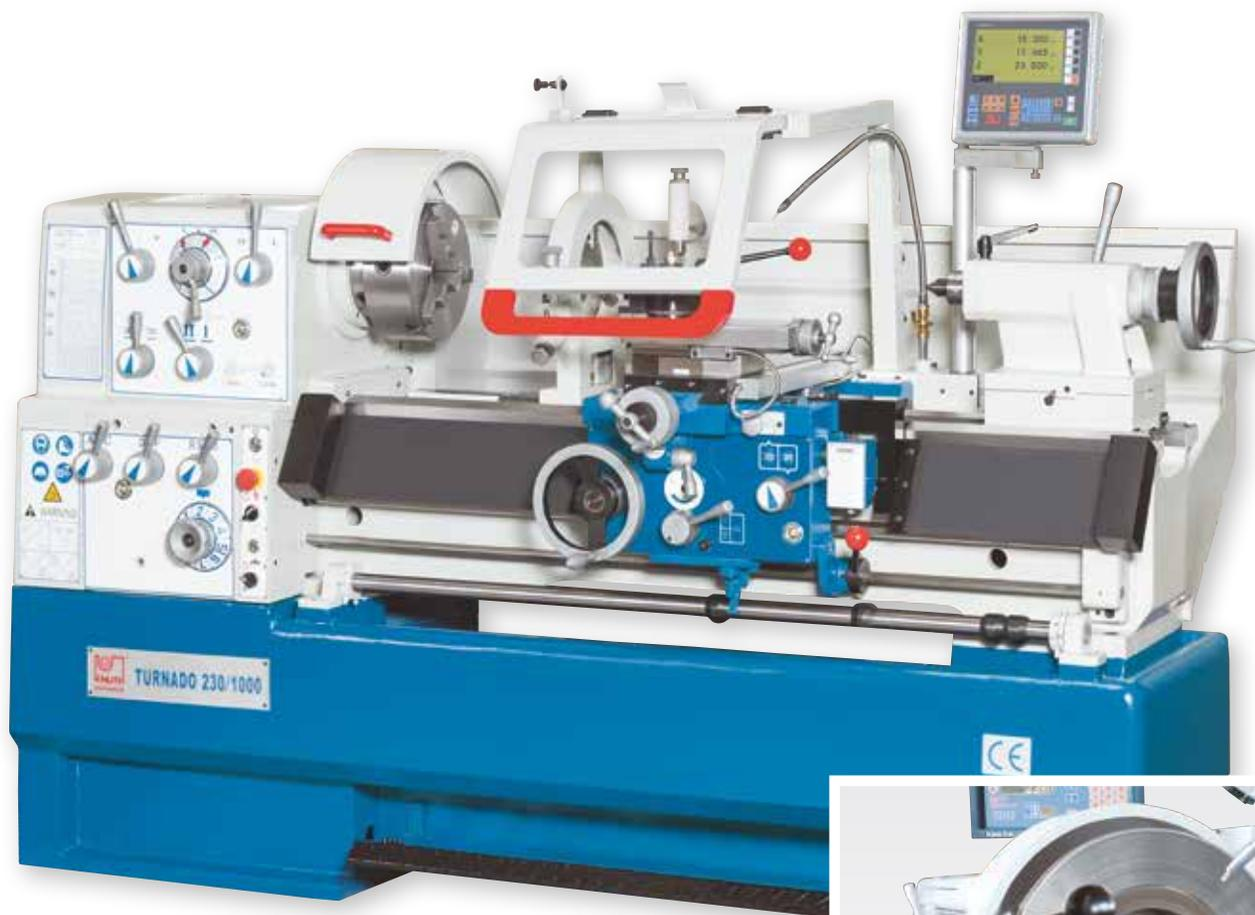
Рис.: Turnado 230/1000 с индикацией положения по 3 осям
