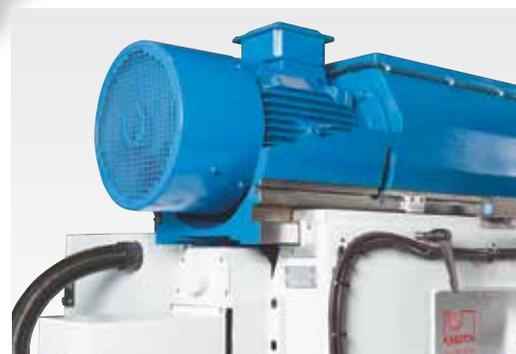
Мощный привод главного шпинделя с зубчатой коробкой передач (Servomill® UWF 12)
