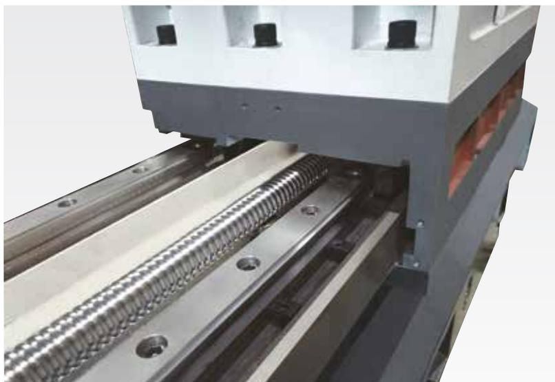
Комбинация больших линейных и плоских направляющих обеспечивает исключительную стабильность
