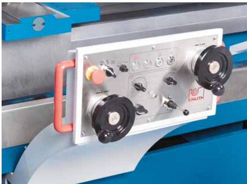
Позиционирование обеих осей может выполняться при помощи соответствующего электронного маховика
