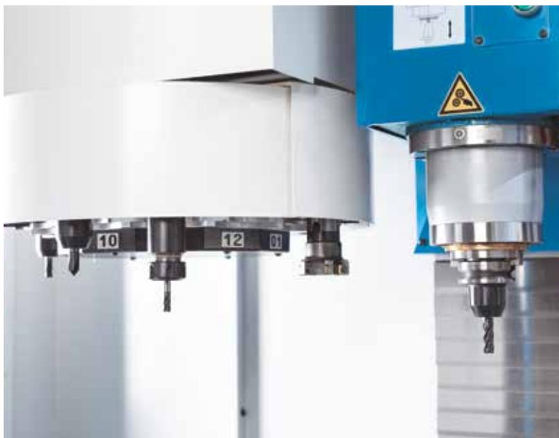
Надежное 12-позиционное горизонтальное устройство смены инструмента
