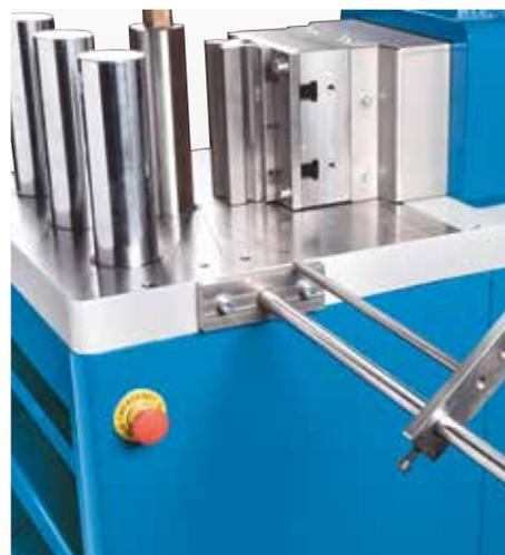
Перемещаемый вручную боковой упор для серийной обработки
