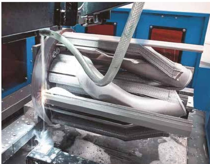
В процессе аддитивного производства сложные компоненты создаются на металлической пластине, которая затем отделяется (NeoSpark 500 B Continental Engineering Services)
