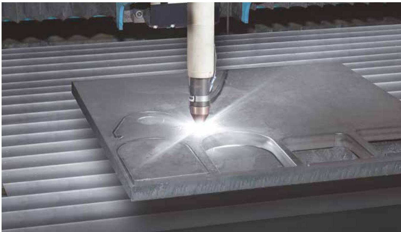
При плазменной резке электрическая дуга между электродом и заготовкой таким образом сужается с помощью режущего сопла, что делает возможным эффективную плазменную резку металлов.
