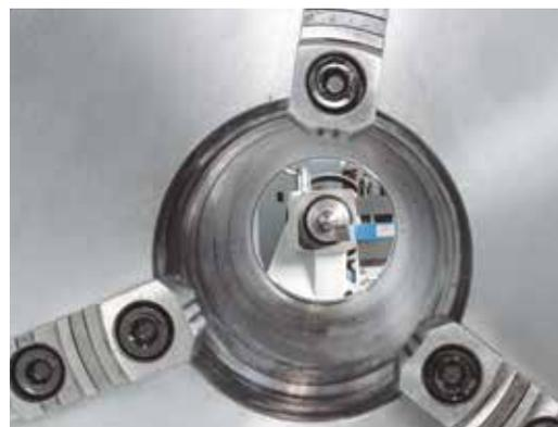
Отверстие шпинделя до 225 мм
