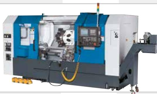
Токарный станок с наклонной станиной
