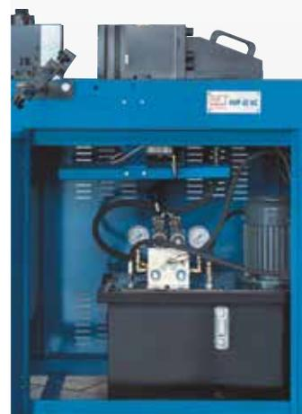
Компактный гидравлический блок расположен в основании и легко доступен
