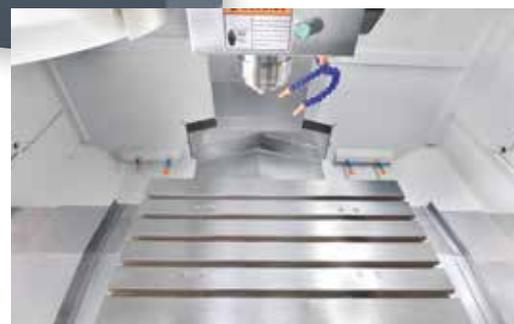
Направляющие по всем осям защищены прочными кожухами из нержавеющей стали
