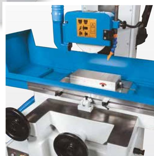
Электромагнитная постоянная зажимная плита с точной настройкой повышает точность шлифования
