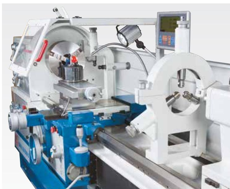
Люнеты для точной обработки длинных заготовок
