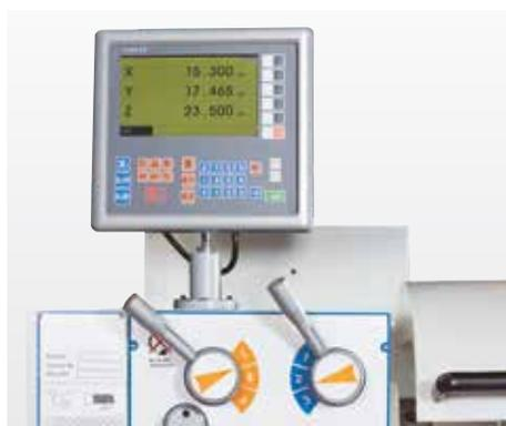
Устройство индикации координат для осей X, Z и Z1
