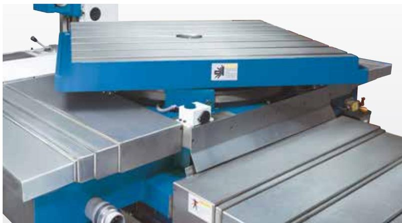
Поворотный рабочий стол с моторизированной подачей фиксируется с помощью гидравлических креплений
