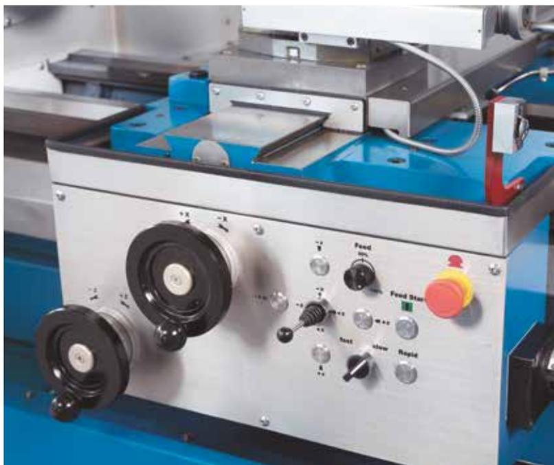
Управление с помощью электронного маховика в диапазоне  $\mu$  - по ощущениям и положению, как на обычном станке
