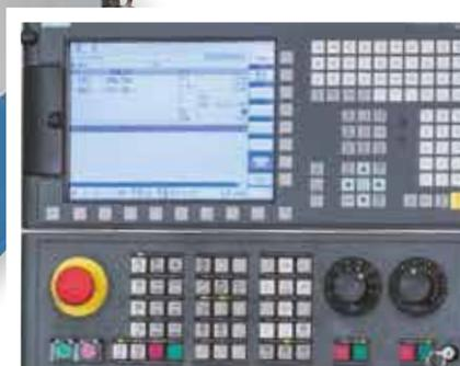
Siemens Sinumerik 828 D Basic - компактное и удобное в использовании решение для токарных станков
