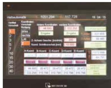
На сенсорном экране плоскошлифовальных станков серии HFS NC компактно и наглядно отображаются и доступны для выбора все функции.
