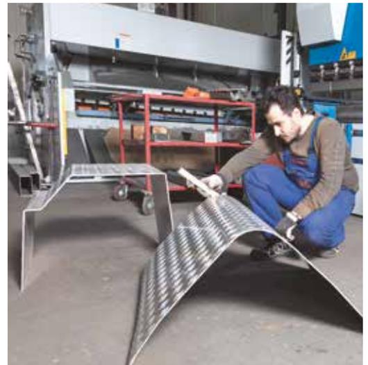
Почти завершённый компонент с радиусом и защитным покрытием для топливного бака длинного грузовика
