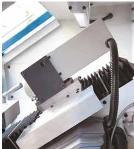
Конструкция с наклонной станиной для оптимального рабочего пространства и удаления стружки
