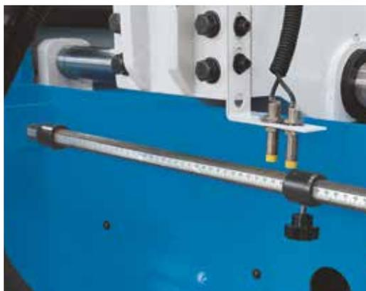
Автоматическая подача заготовки с помощью подвижных тисков, ход которых настраивается вручную при помощи выступа
