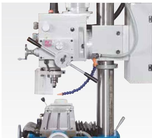
Автоматическая подача пиноли 3-ступенчатой коробкой передач
