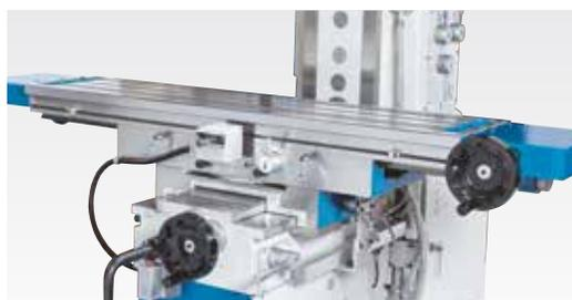
фрезерный стол снабжен большой зажимной поверхностью и может двигаться в продольном направлении
