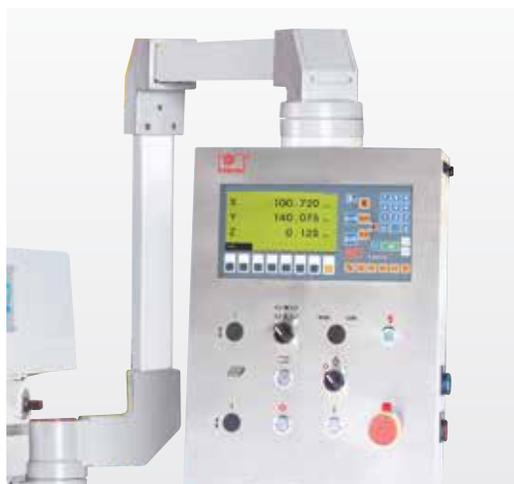
Откидная панель управления со встроенной индикацией координат - для комфортной работы
