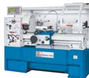
Классический токарный станок с сервоприводом
