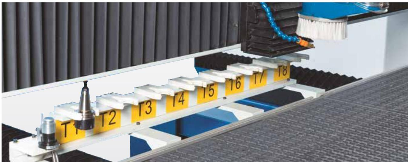
Линейный 8-позиционный узел смены инструмента
