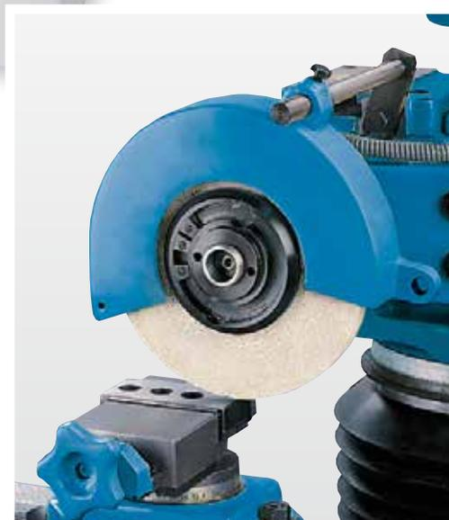
Плоское шлифование с поворотными тисками
