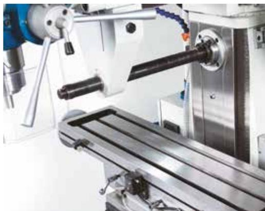
Прочная верхняя траверса с контрдержателем обеспечивает надежный зажим длинных фрезерных оправок
