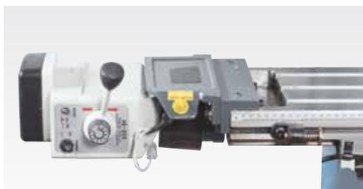
Перемещение стола фрезерного станка с бесступенчатым регулированием
