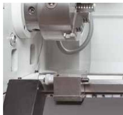
Микрометрический упор станины гарантирует высокую точность повтора
