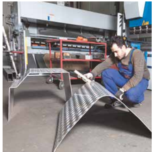
Componentă aproape finalizată cu rază, capac de protecție pentru rezervorul de combustibil al unui camion pentru bușteni lungi
