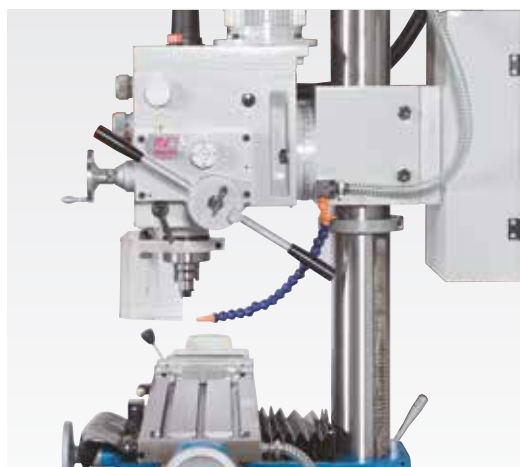
Avans automat pinolă cu angrenare în 3 trepte
