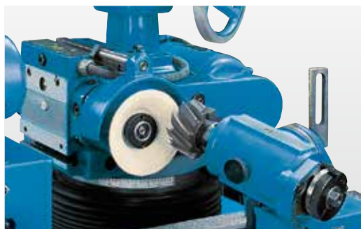
Sistem stabil de fixare piese cu unghi reglabil
