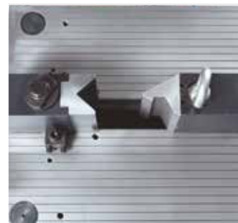
Poansonul de îndoire se deplasează în ghidaje de susținere lungi, dure, care sunt alimentate cu ulei de către lubrifierea centrală
