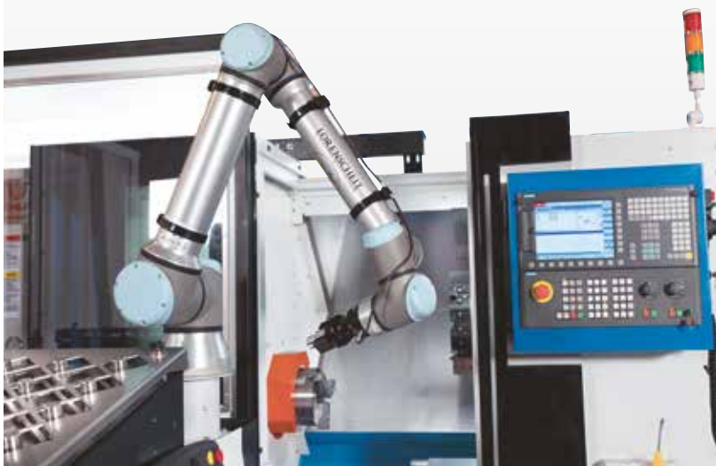
Braț de robot cu 6 axe cu o rază de lucru de 1.300 mm
