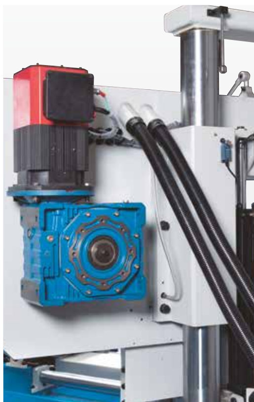
Servomotor reglabil fără trepte, cu cuplu ridicat
