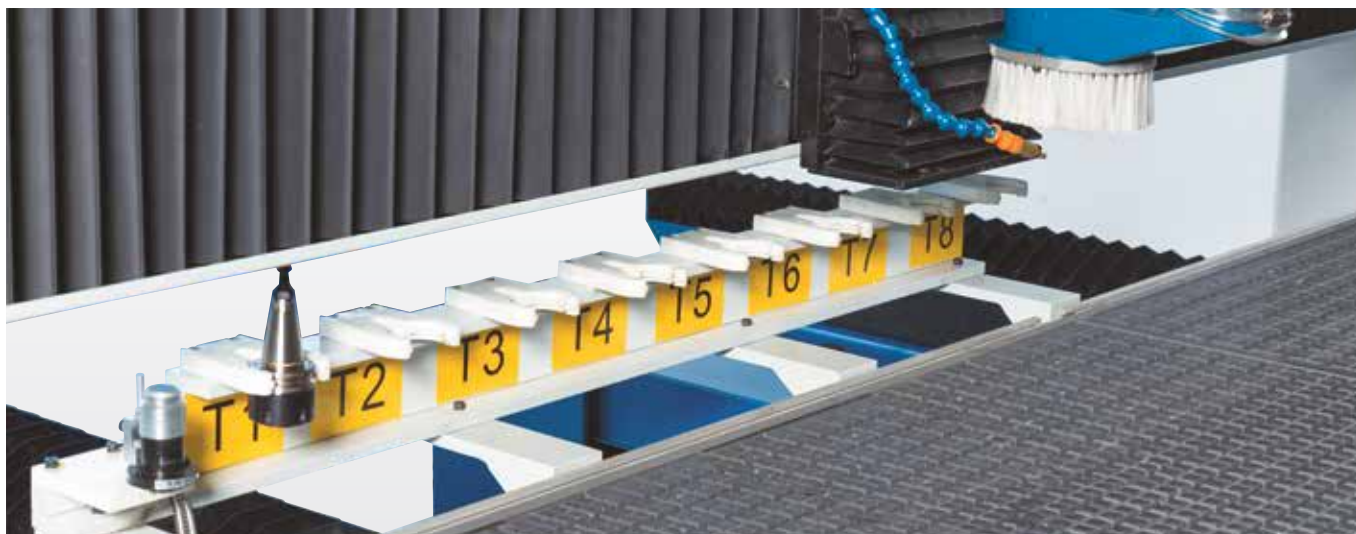
Schimbator de scule liniar cu 8 posturi
