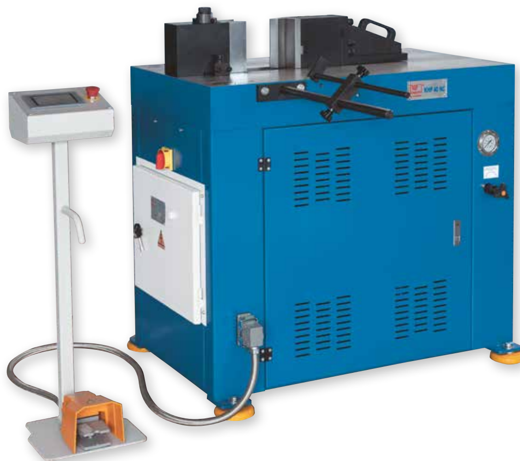
Unitatea hidraulică compactă este amplasată accesibil în batiu
