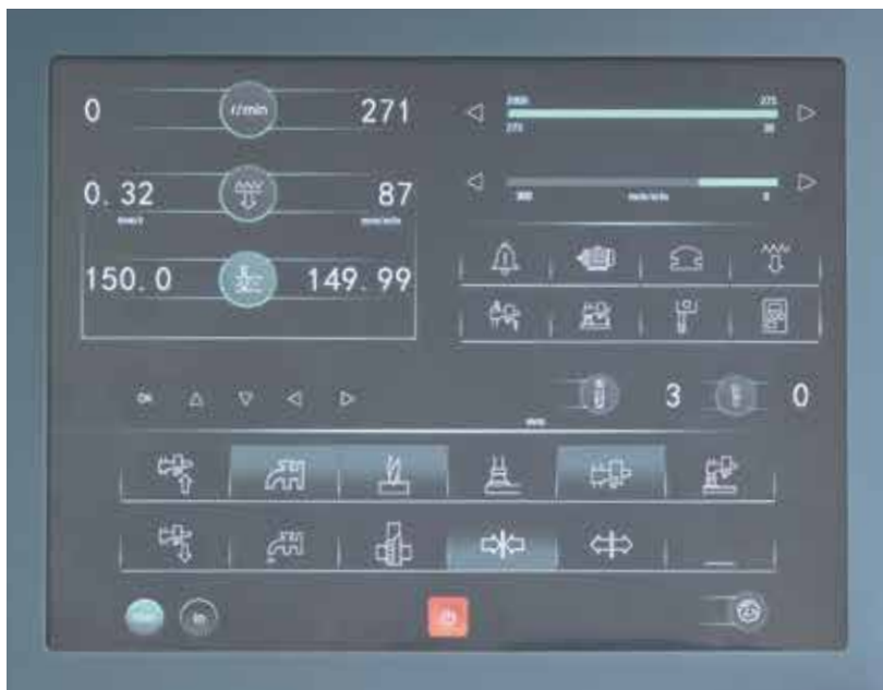
Toate funcțiile sunt reprezentate grafic pe ecranul cu touch-screen
