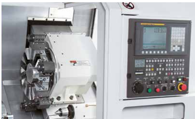
Turelă cu servomotor și selecție bidirecțională a uneltelor
