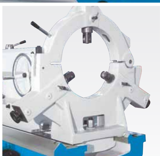
Lineta fixa cu diametru de trecere mare
