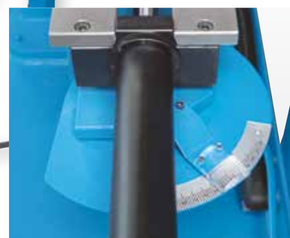
Unghiul de tăiere poate fi ajustat cu precizie și poate fi citit exact
