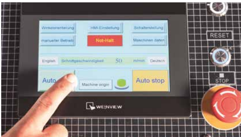
În modul automat pot fi programate lungimea avansului, unghiul de tăiere și numărul de pași din configurarea în cauză
