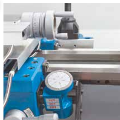
Ceasul de filetare asigura continuarea pasului de filetare dupa deschiderea piulitei de blocare pentru miscarea de retur
