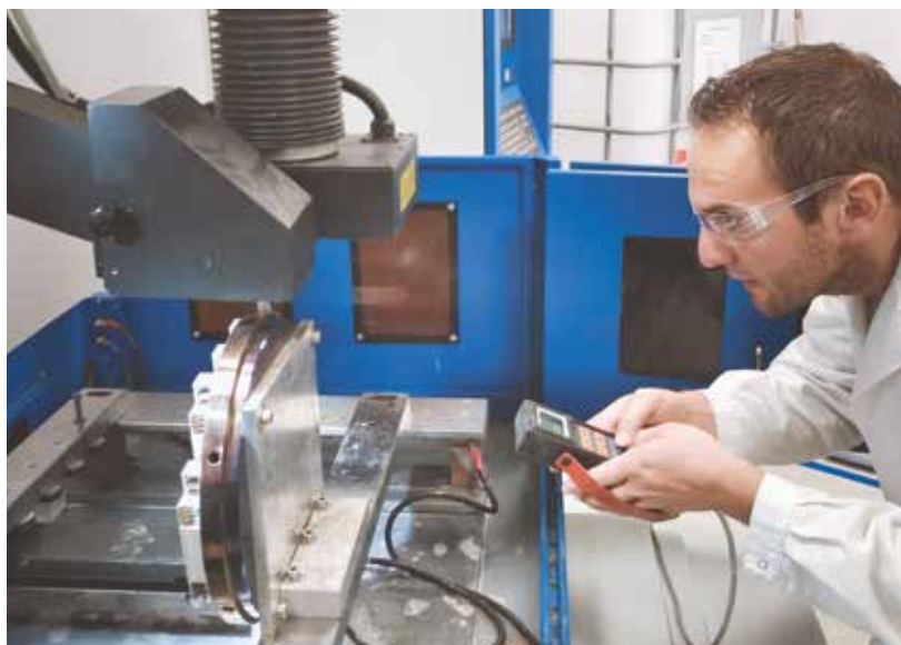
Pentru o debitare perfectă se înregistrează geometria piesei prelucrate. Aici s-a prelucrat o platformă de construcție cu componente din oțel inoxidabil.
