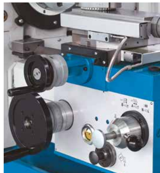
Ungerea centralizata este integrata in suport ceea ce usureaza mentenanta si operarea
