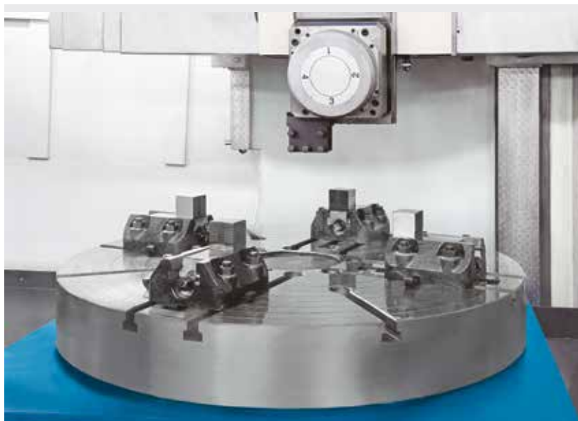
Platou si schimbator de scule cu 4-locase
