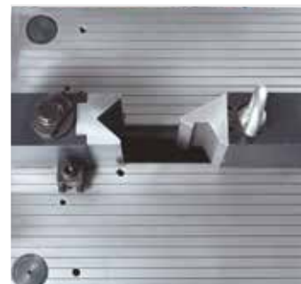
Stempel gnący przesuwany w podpieranych na długość utwardzonych prowadnicach, do których olej jest doprowadzany przez jednostkę smarowania centralnego
