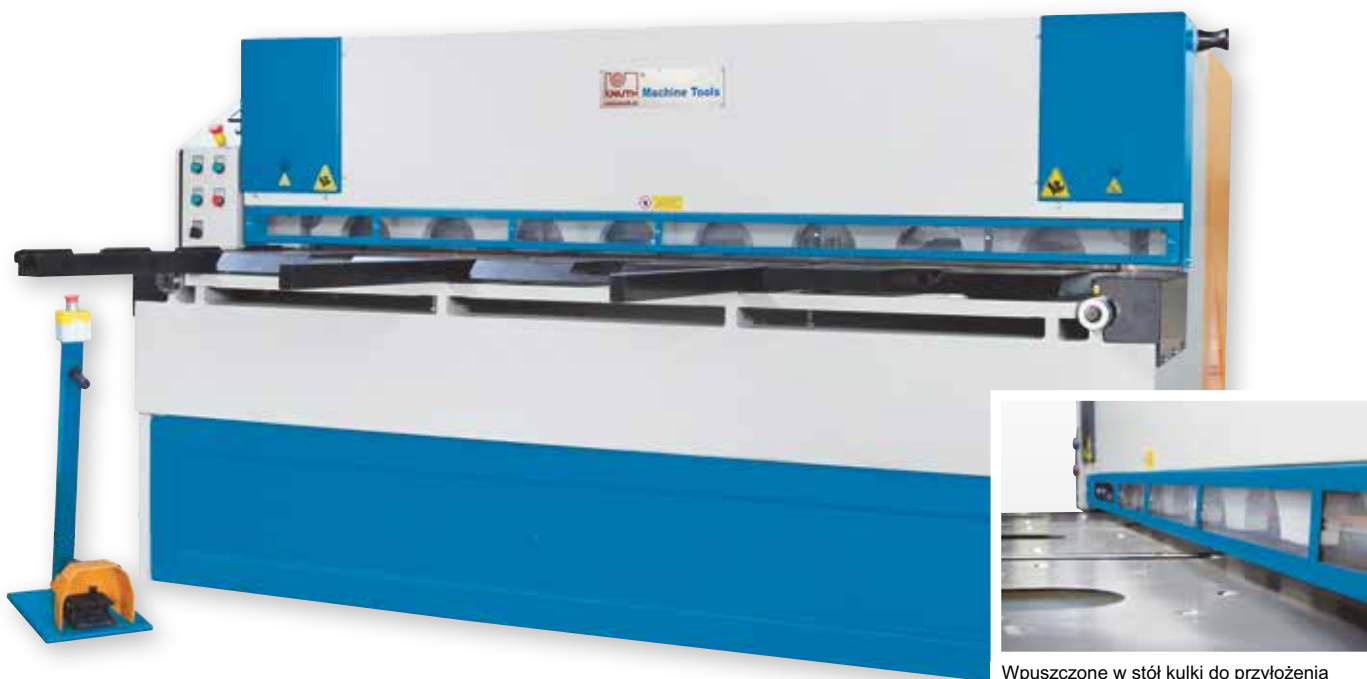
Wpuszczone w stół kulki do przyłożenia materiału ułatwiają obróbkę detali
