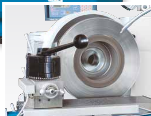
Turnado V: Stała prędkość skrawania gwarantuje idealną powierzchnię
