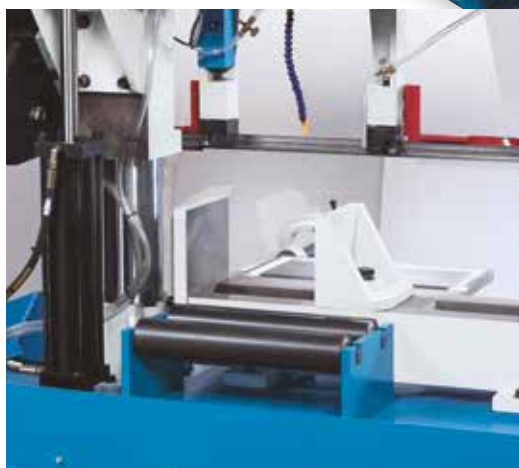
Nakładka roczna do łatwego prowadzenia materiału
