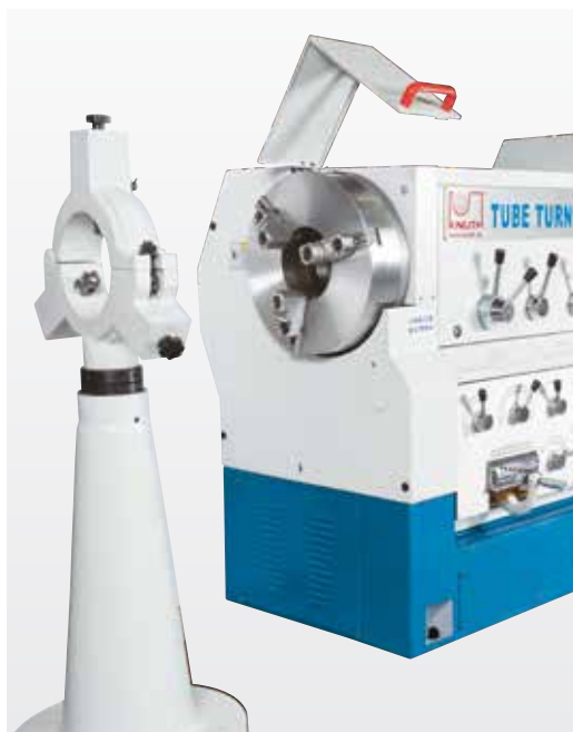
Tylny uchwyt nadaje długim elementom obrabianym stabilności
