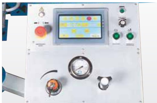
Panel obsługowy z graficznym wyświetlaczem z ekranem dotykowym sterownika
