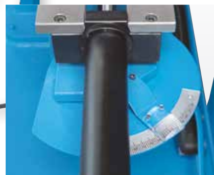
Kąt cięcia jest precyzyjnie regulowany i można go dokładnie odczytać
