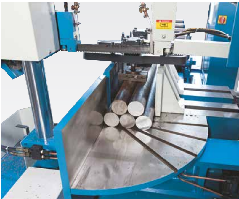
Hydrauliczne urządzenie do mocowania wiązki do obu imadeł, seryjne
