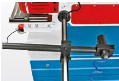
Ogranicznik tylny z automatycznym rozpoczęciem skrawania
