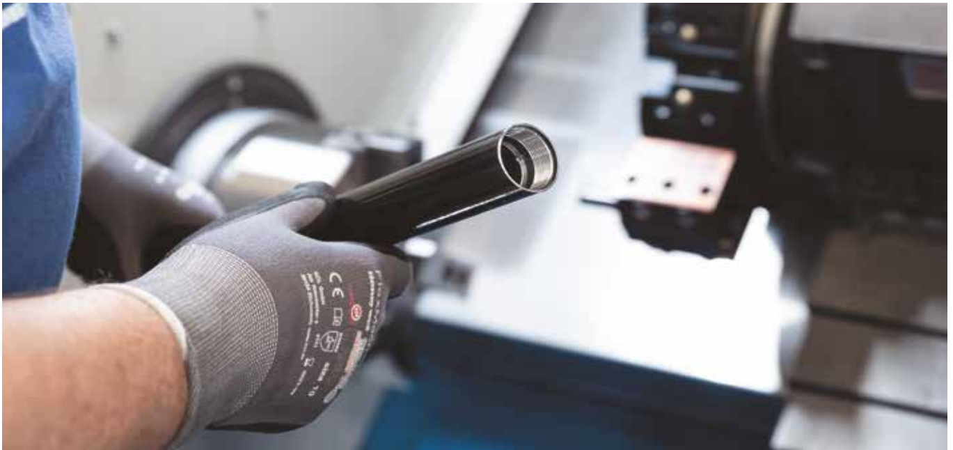
Podczas toczenia gwintów potrzebna jest największa precyzja. Rury stalowe są łączone później dokładnie z przewodami suchych instalacji tryskaczowych.
