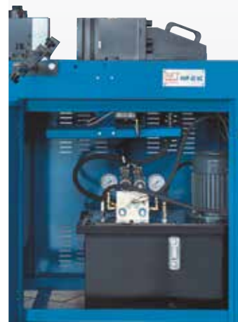
Kompaktowa jednostka hydrauliczna jest zamocowana dobrze dostępna w stojaku dolnym
