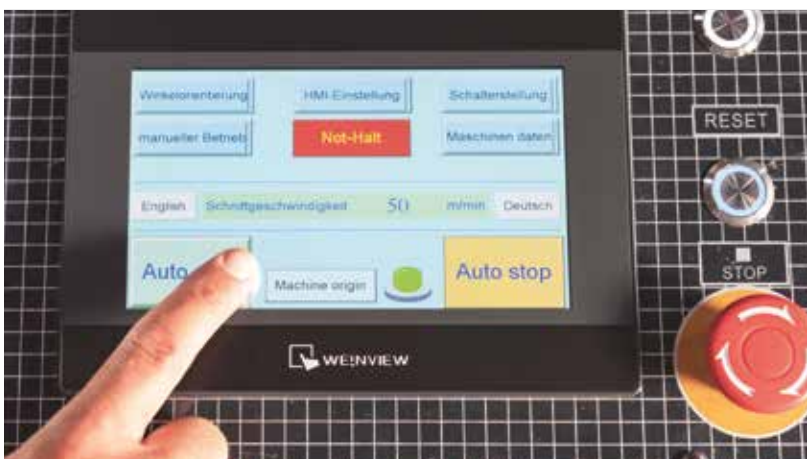
W trybie automatycznym możliwe jest programowanie długości posuwu, kąta cięcia oraz liczby cięć w poszczególnych konfiguracjach
