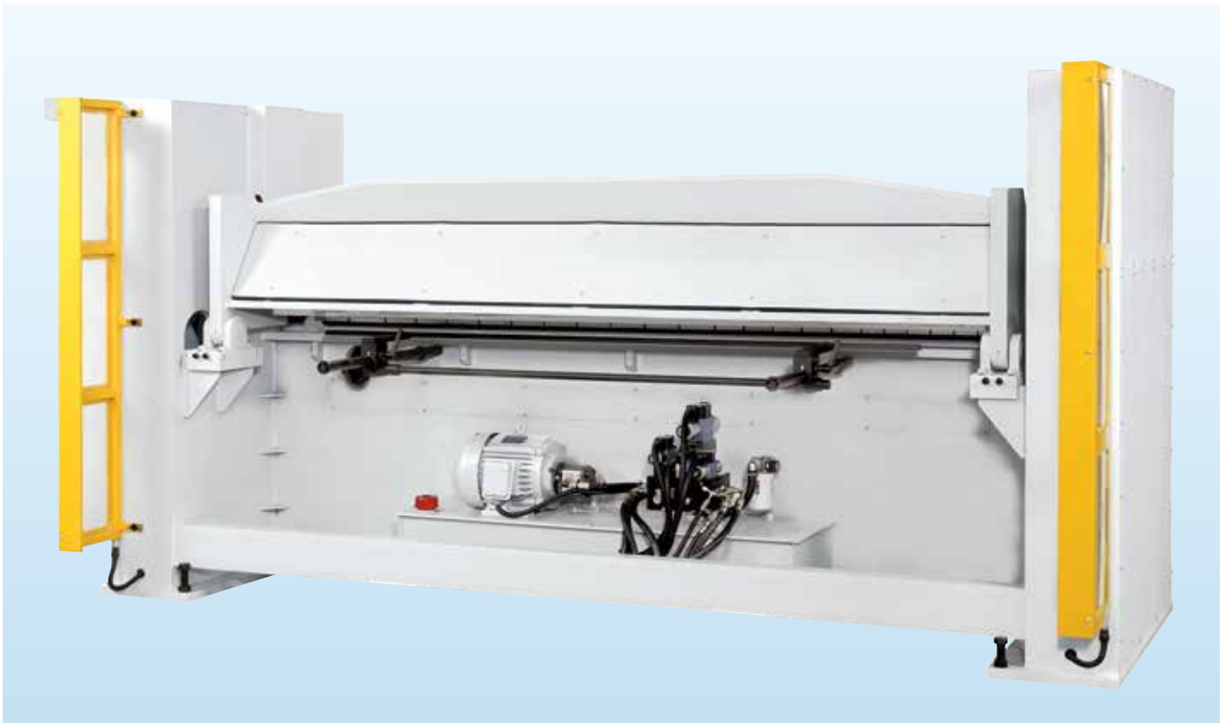
Widok maszyny z tyłu - ręczny ogranicznik tylny
