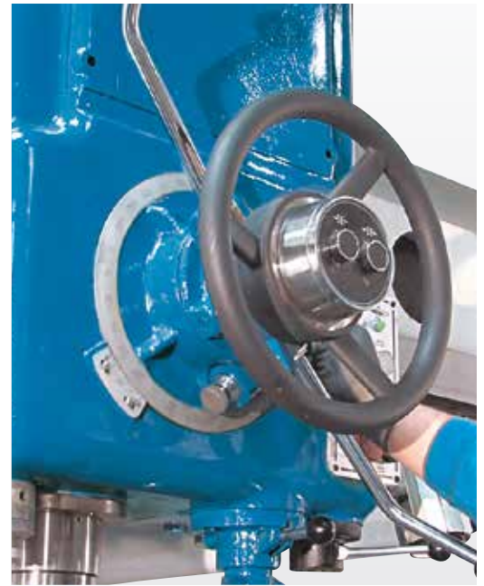
Ogranicznik głębokości z noniusem
