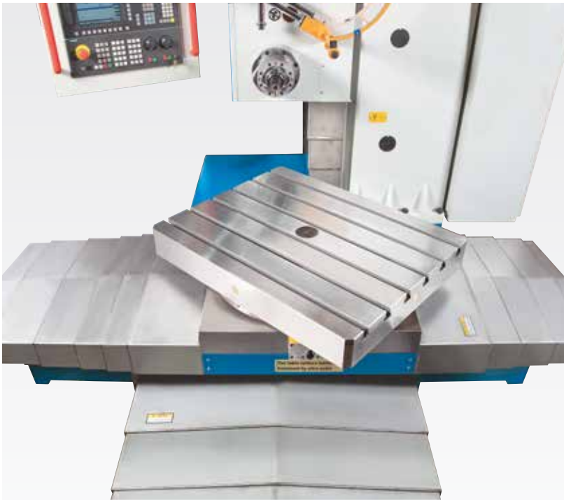
Stół roboczy obracany o 360° z hartowaną powierzchnią
