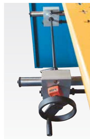
ręczny ogranicznik tylny z licznikiem cięcia
