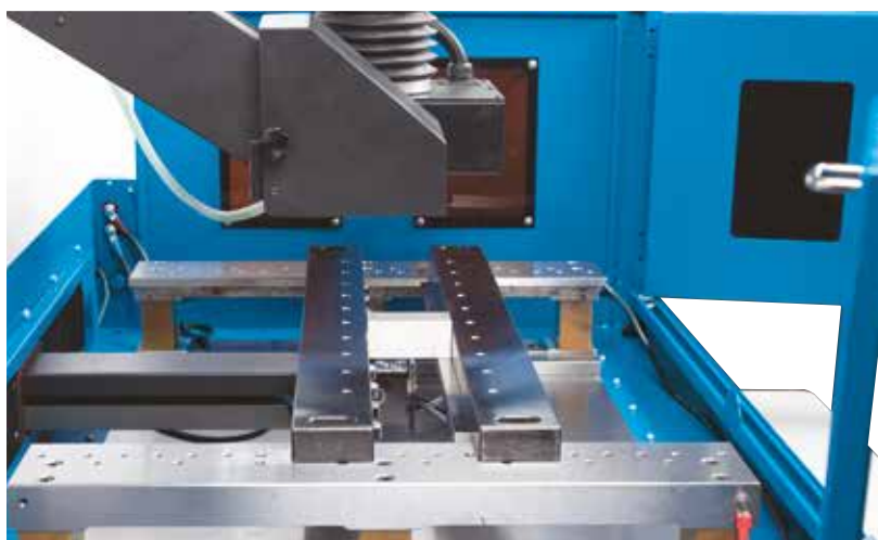
Erodowanie wysokostopowej stali narzędziowej nie stanowi problemu dla NeoSpark 500.
