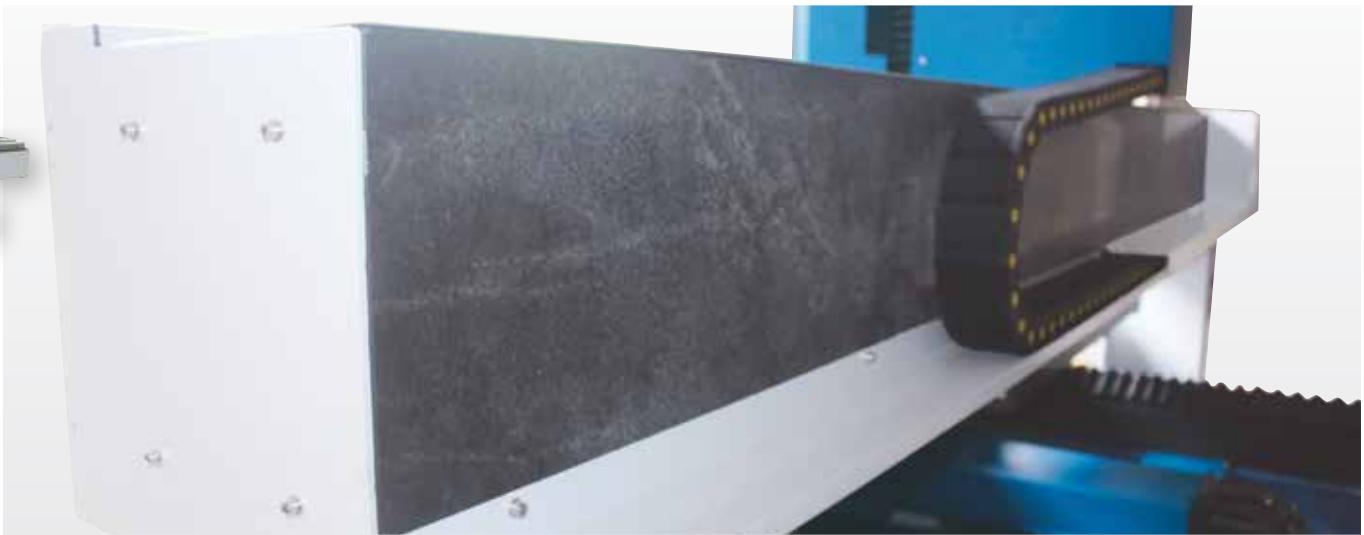
Precyzyjnie oszlifowane elementy granitowe we wszystkich osiach
