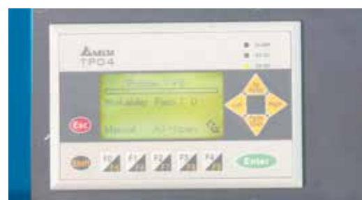
Il controllo del magazzino barre viene parametrizzato mediante il chiaro pannello di comando
