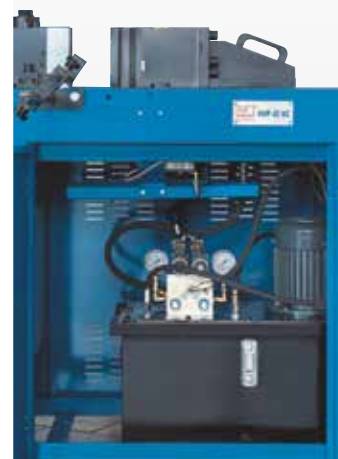
L'unità idraulica compatta è posizionata nel basamento ed è facilmente accessibile
