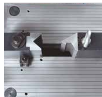
Lo stampo di piegatura scorre su lunghe guide di supporto temprate, lubrificate mediante un sistema centralizzato
