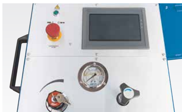
Controllo PLC con display grafico touchscreen
