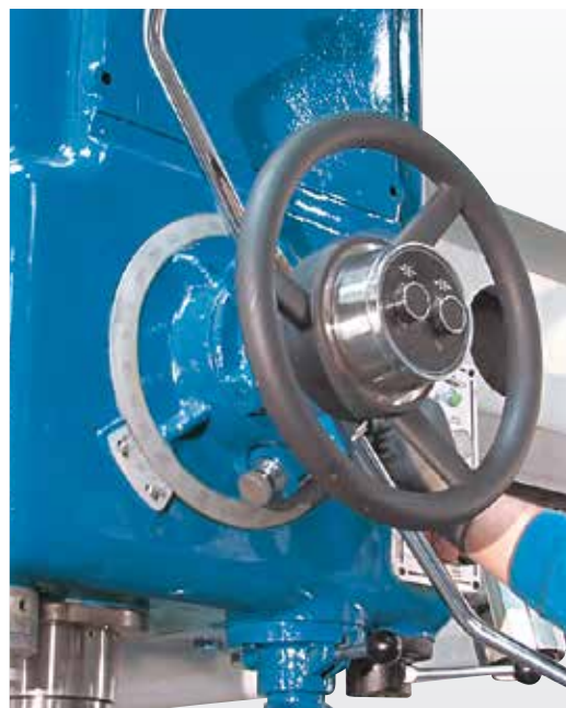
Arresto di profondità con nonio di misurazione
