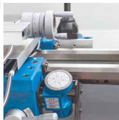
Il calibro per filetti garantisce la ripresa del processo di filettatura dopo che la vite madre è stata aperta per il movimento di ritorno
