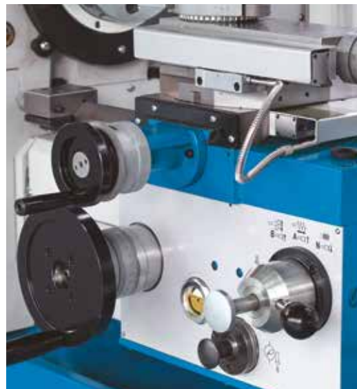
Il sistema di lubrificazione centralizzata integrato nel carrello garantisce facilità di manutenzione e semplicità d'uso
