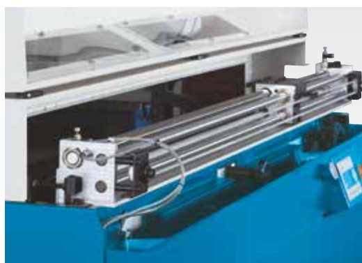
Lavorazione flessibile di materiale in barre sino a 65mm di diametro
