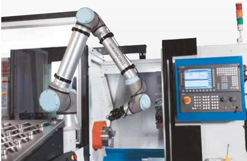
Braccio robot a 6 assi con raggio d'azione di 1300mm
