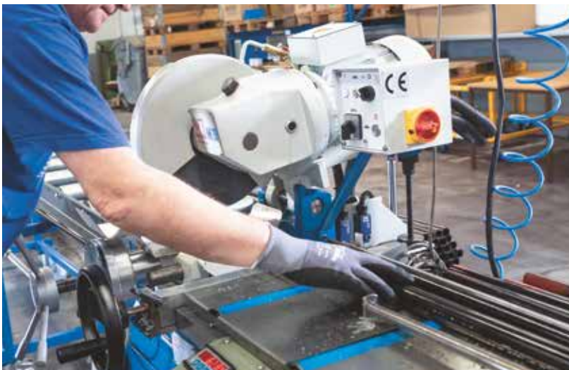
Die Vorarbeit leistet bei Minimax die KHK 350 halbautomatische Kreissäge mit pneumatischer Werkstückklemmung, ebenfalls von KNUTH. Sie bringt die Stahlrohre millimetergenau auf die richtige Länge.
