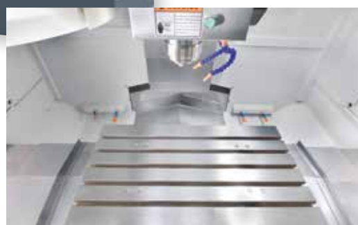
Le guide di tutti gli assi sono protette da ripari in acciaio inox
