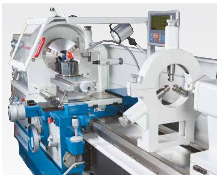
lunette per la lavorazione di precisione di pezzi lunghi
