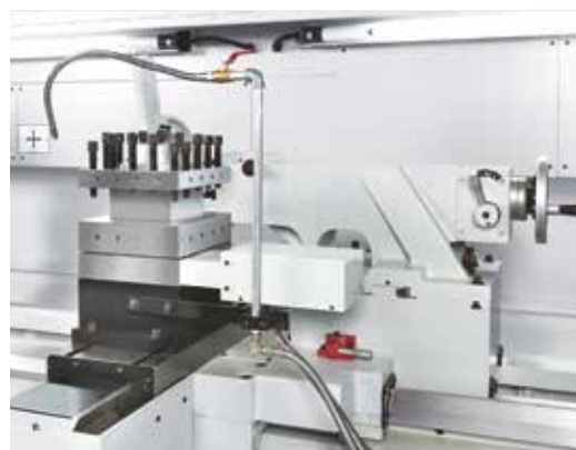
Facilità d'uso: per il posizionamento la contropunta può essere accoppiata al carrello
