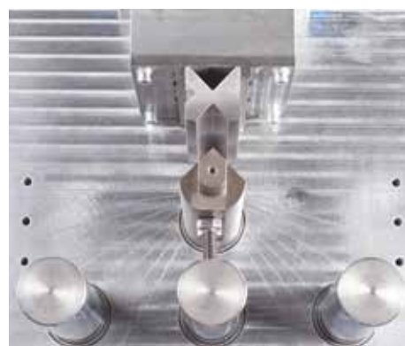
Le linee angolari sono incise sulla tavola di lavoro per orientare l'operatore
