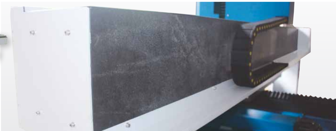
Elementi in granito microrettificati su tutti gli assi
