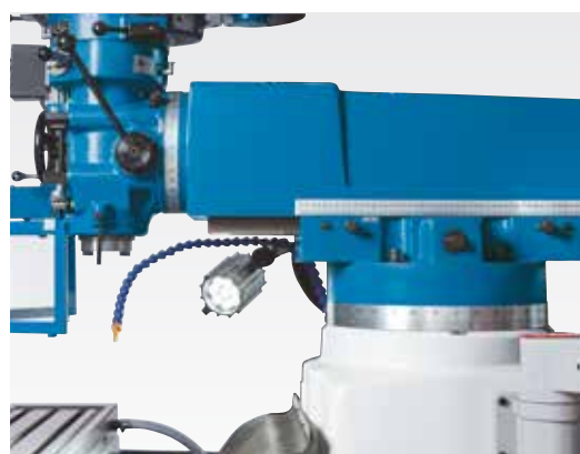
Sbalzo ed angolo di lavorazione variabili
