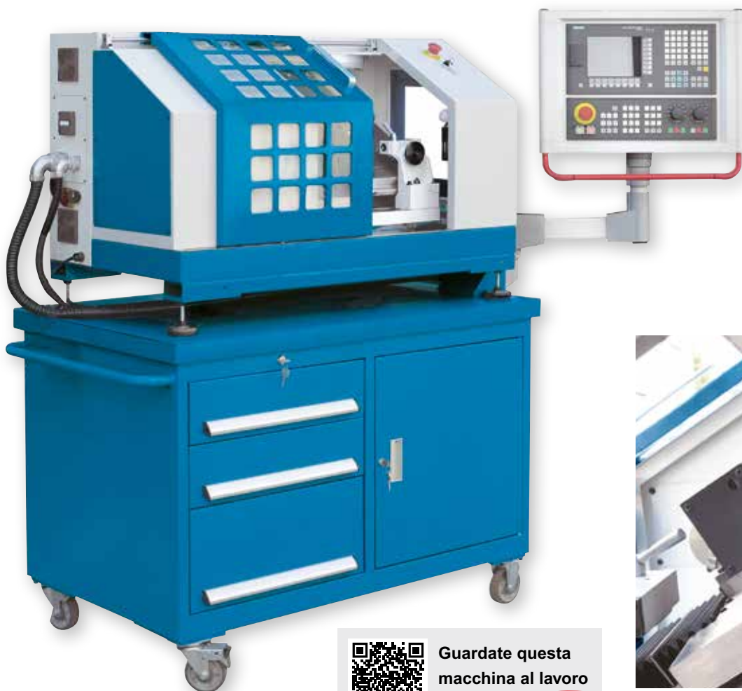
Struttura a bancale inclinato per ottimizzare l'area di lavoro e la rimozione dei trucioli
