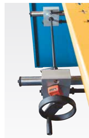
riscontro posteriore manuale con contatore
