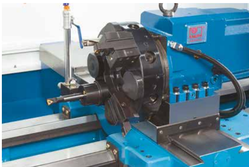
Portautensili VDI a revolver a 8 posizioni
