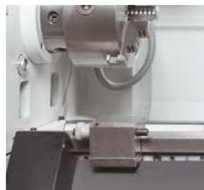
l'arresto micrometrico sul bancale garantisce la precisione di ripetibilità
