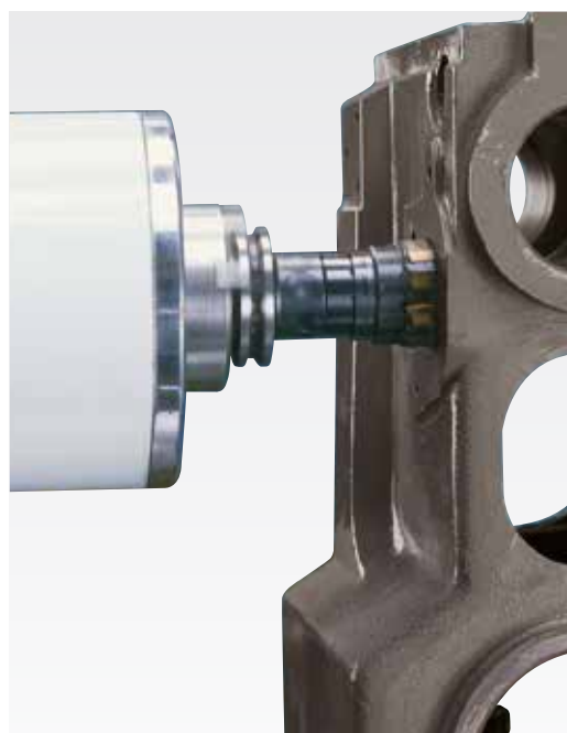
lavorazione multi-lato mediante tavola girevole
