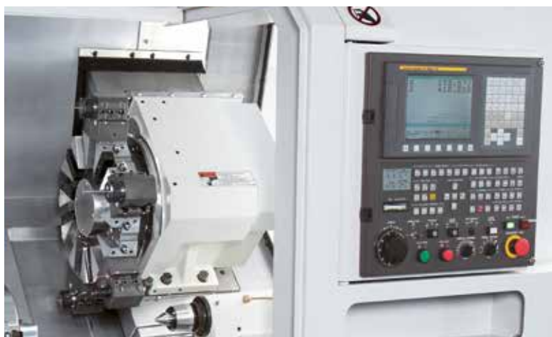
Torretta revolver motorizzata con scelta utensile bidirezionale
