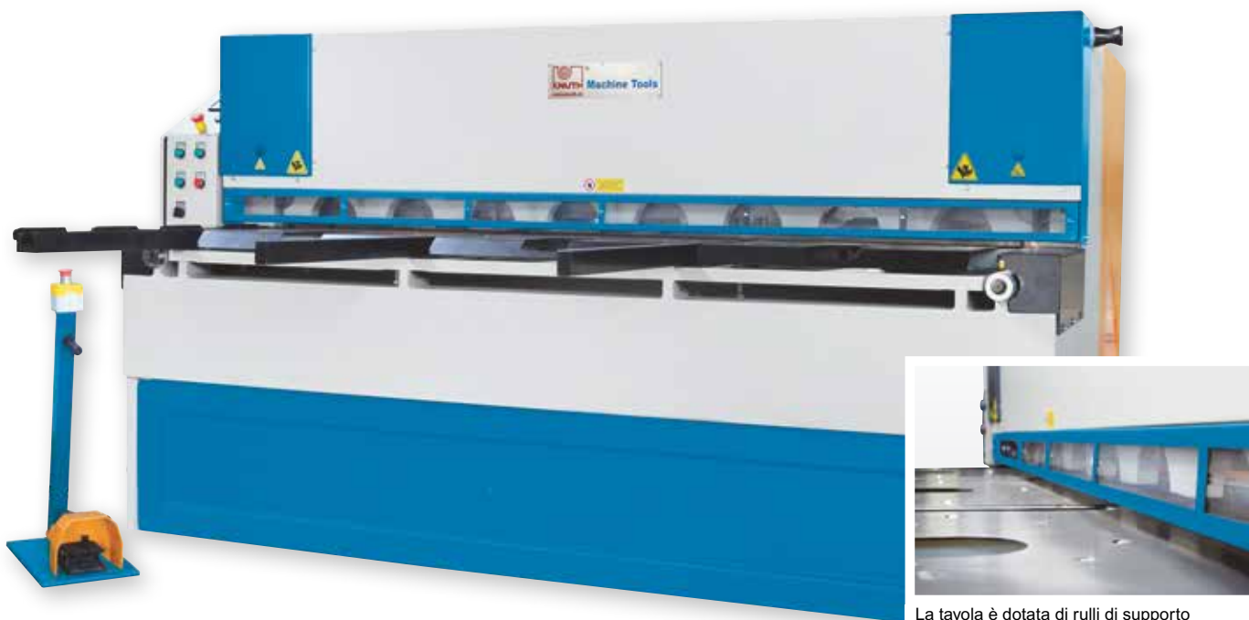
La tavola è dotata di rulli di supporto integrati che facilitano la movimentazione del materiale
