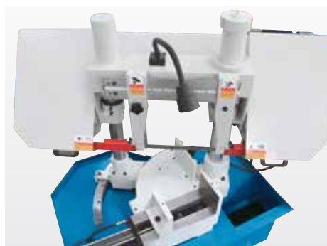
Telaio orientabile con guida a doppia colonna
