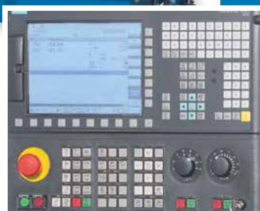
Siemens Sinumerik 828 D Basic T - la soluzione compatta e semplice per torni
