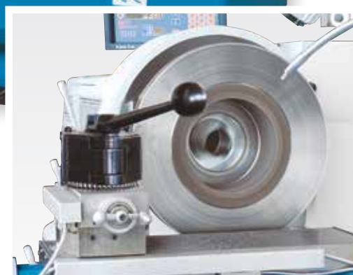
Turnado V: Vitesse de découpe constante pour une surface parfaite
