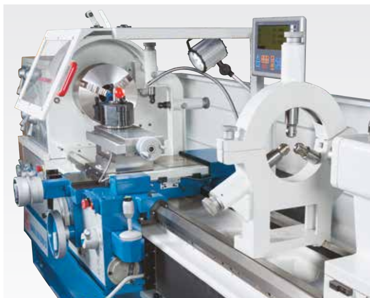
Lunettes fixes pour un usinage précis de pièces longues
