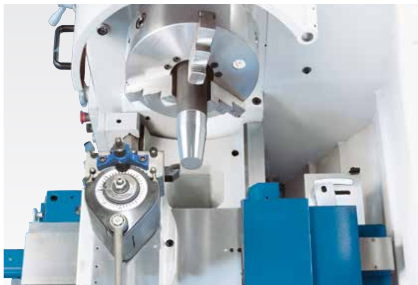
Dispositif de tournage conique (de série)
