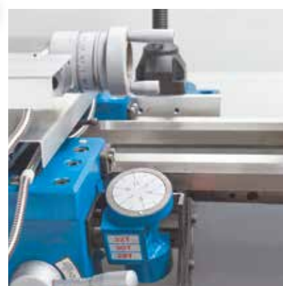
La jauge de filetage garantit la reprise du filetage après ouverture de la vis femelle pour procéder au mouvement rétrograde
