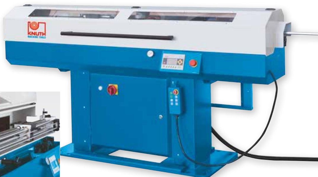
Usinage flexible de barres de matériau jusqu'à 65 mm de diamètre
