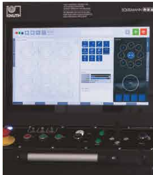
Unité CNC Eckelmann avec écran tactile 19" pour modèles TrueCut K
