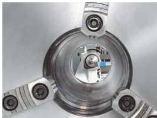
Passage de broche jusqu'à 225 mm
