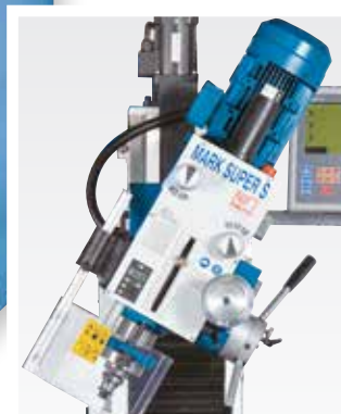
Tête pivotante à \pm 45^\circ
