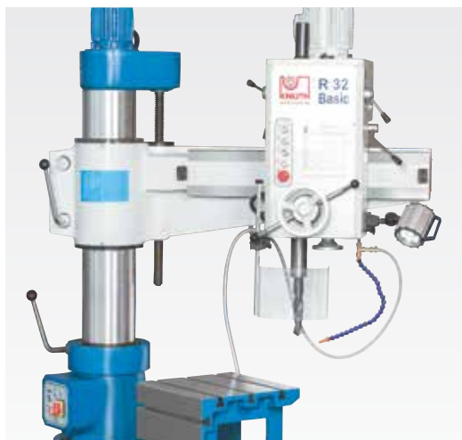
Flèche pivotante avec charge élevée
