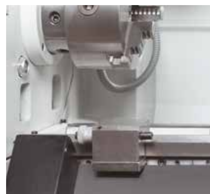
La butée de banc micrométrique garantit la précision de répétabilité
