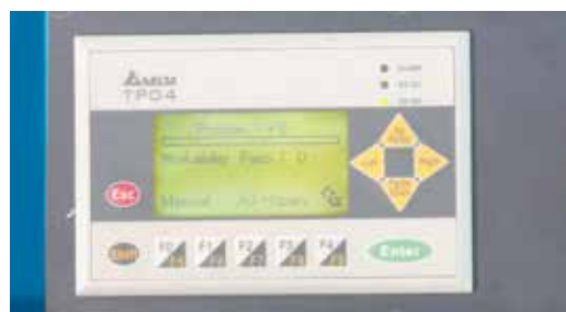
La commande du magasin de barres est paramétrée sur le panneau de commande clairement agencé
