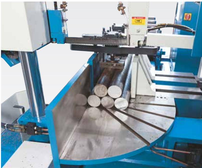
Dispositif de serrage de faisceaux hydraulique pour les deux étaux de série
