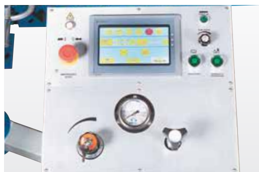
Panneau de commande avec écran graphique tactile de la commande
