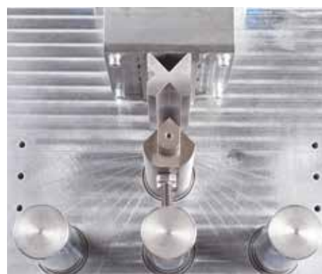
Des lignes d'angles sont gravées sur la table de travail pour l'orientation
