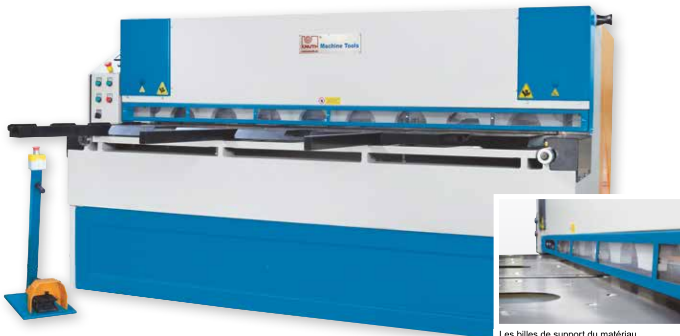
Les billes de support du matériau encastrées dans la table facilitent la manutention des pièces
