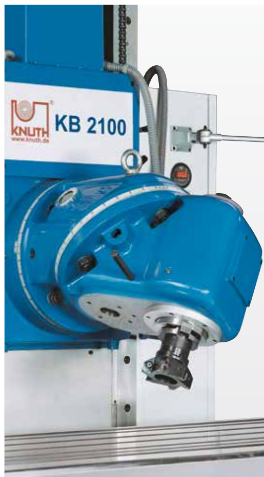
Réglage dans chaque angle via 2 plans de pivotement
