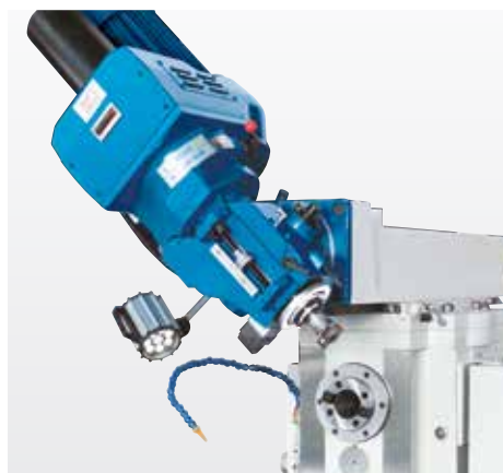
Tête de fraisage pivotable jusqu'à 45°
