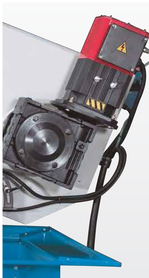
Vitesse de ruban réglable en continu via servomoteur
