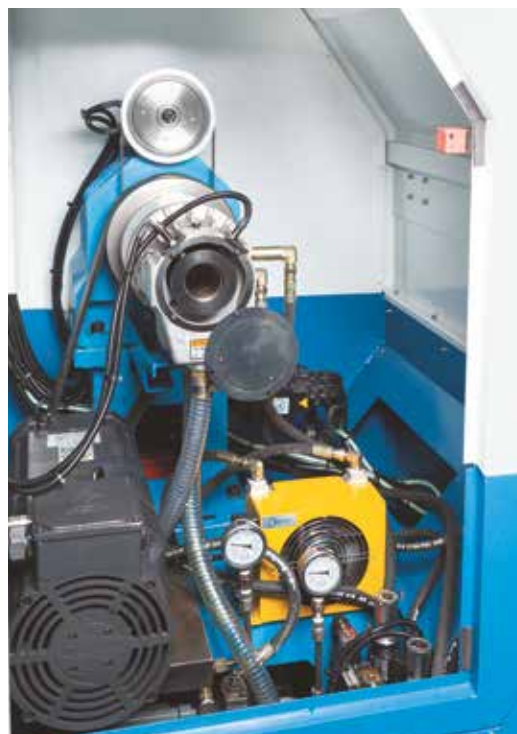
Le passage de broche dans le tube de traction est de 48 mm
