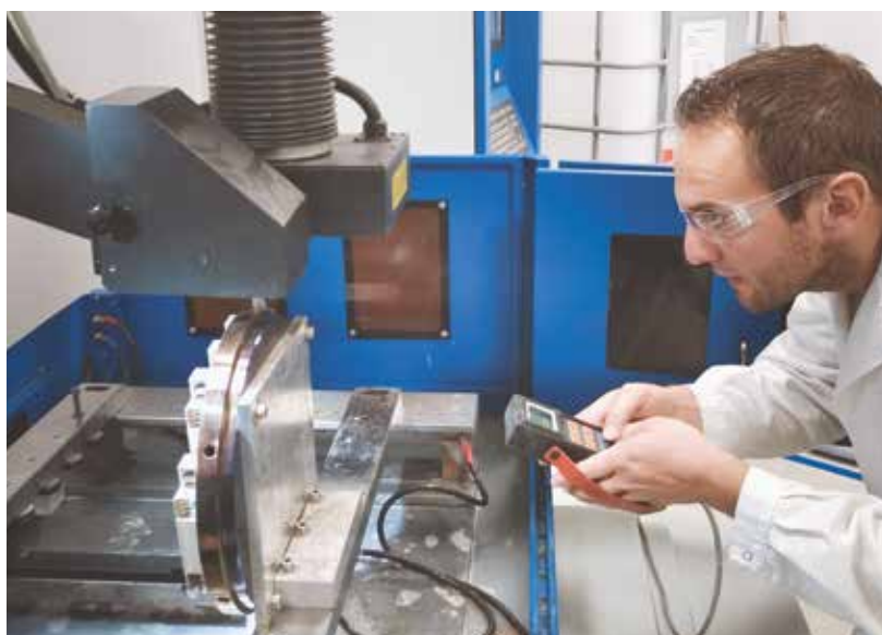
La géométrie de la pièce est programmée pour une séparation parfaite. Ici une plaque de base avec des composants en acier inoxydable a été usinée.
