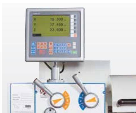
Affichage de position des axes X, Z et Z1
