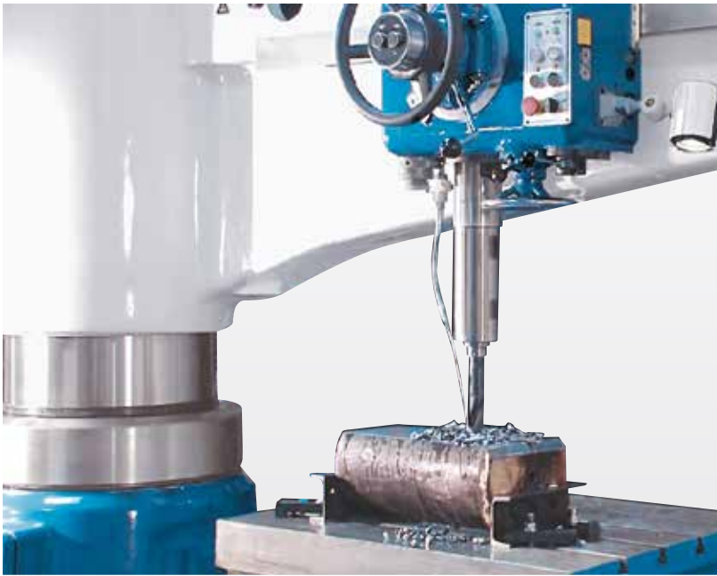
Enlèvement efficace des copeaux par avance automatique
