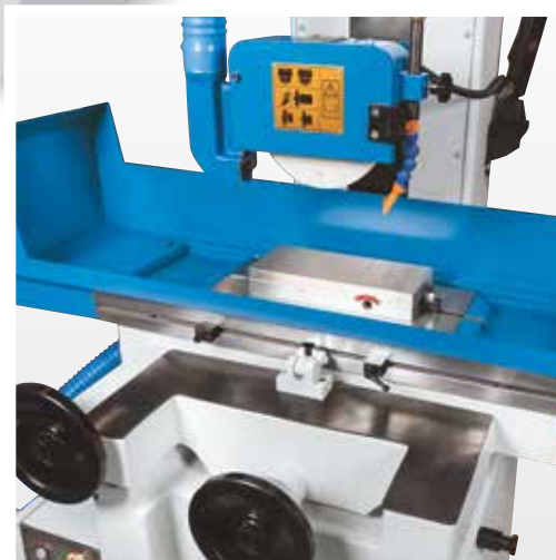
Plaque de serrage à aimant permanent avec pas polaire précis, idéal pour une opération de meulage précise
