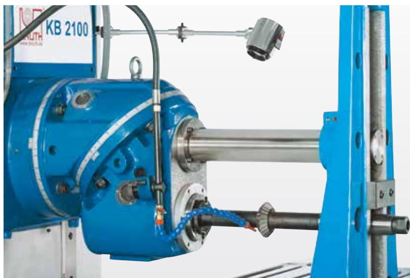
Système de contre-support robuste pour les longs mandrins de fraiseage
