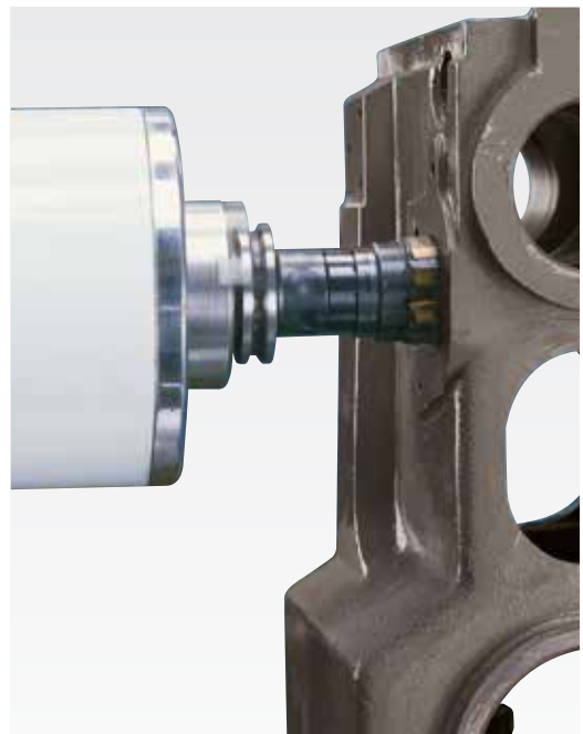
Usinage multifaces avec table pivotante
