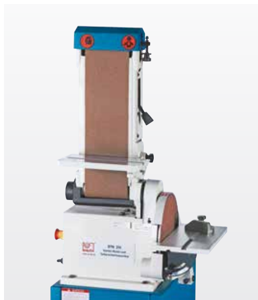
Surface de rectification verticale avec table de support
