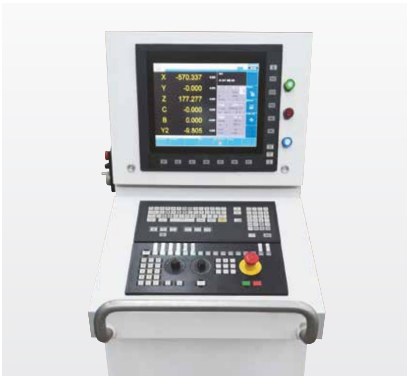
Commande CNC puissante au design ergonomique
