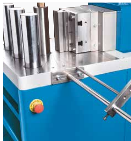
Butée latérale manuelle pour le travail en série
