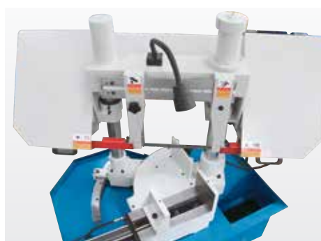
Cadre de scie pivotant, entraînement à double colonne
