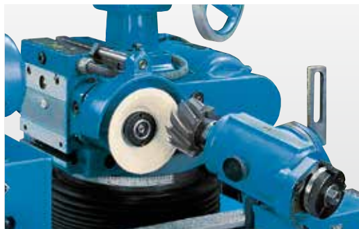
Supports d'outils robustes pivotants
