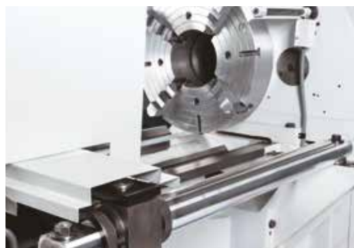
Dispositif de tournage conique de série
