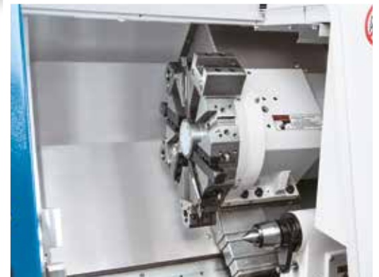
Torreta con servomotor de un Orion 10 TL
