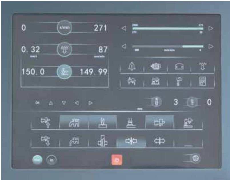
Todas las funciones se muestran en la pantalla gráfica táctil
