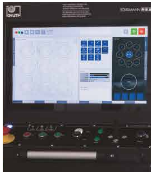
Unidad CNC Eckelmann con pantalla táctil de 19 pulgadas para los modelos TrueCut K
