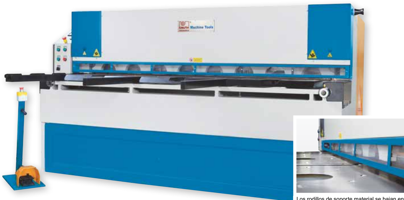
Los rodillos de soporte material se bajan en la mesa para una manipulación sencilla de las piezas de trabajo
