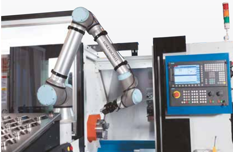
Brazo robótico de 6 ejes con un radio de trabajo de 1300 mm
