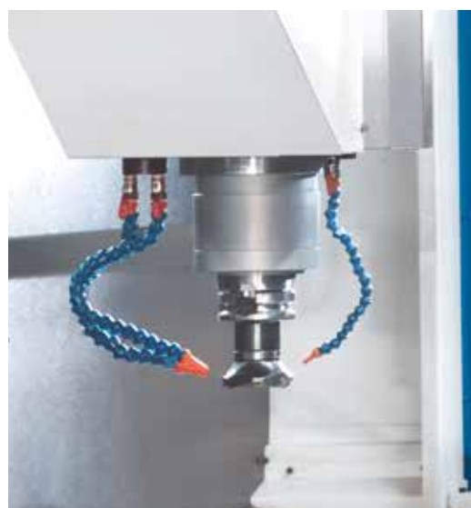
Montaje del husillo con cabezal de corte
