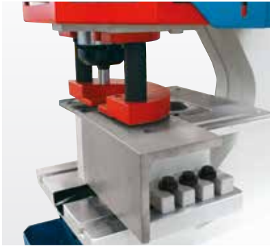
Estación de perforado con gran mesa de soporte
