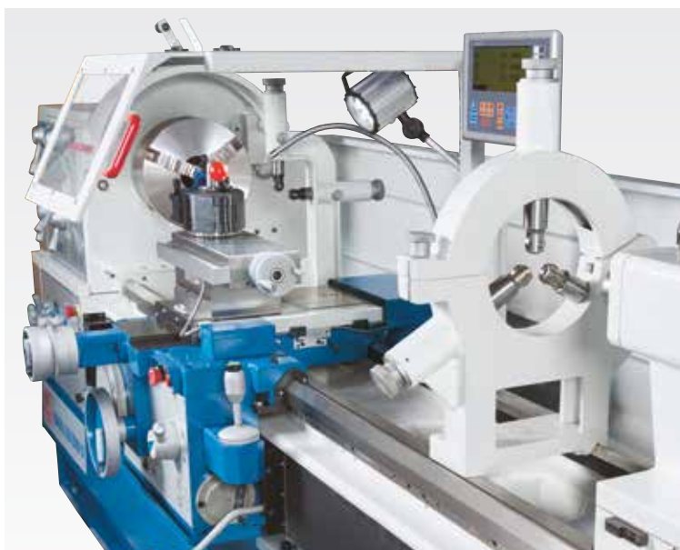
Los soportes aseguran una precisión máxima cuando se maquina en piezas de trabajo
