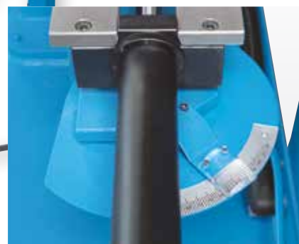
El ángulo de corte se ajusta con precisión y se puede leer fácilmente
