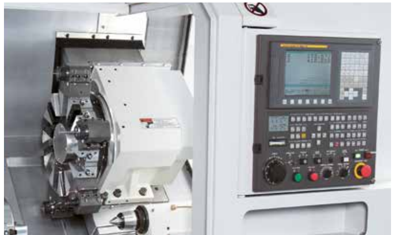
Torreta con servomotor y selección bidireccional de herramientas
