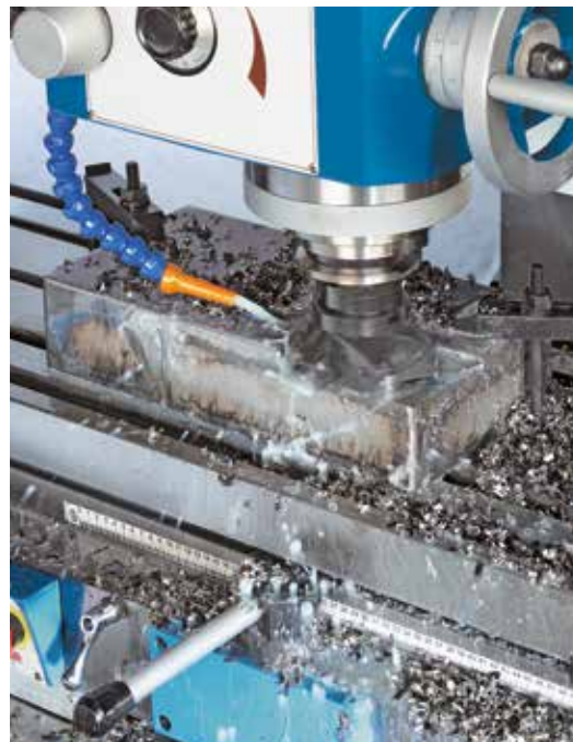
Fresado frontal con cabezal de medición
