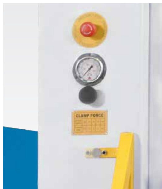
Presión de sujeción del troquel superior ajustable
