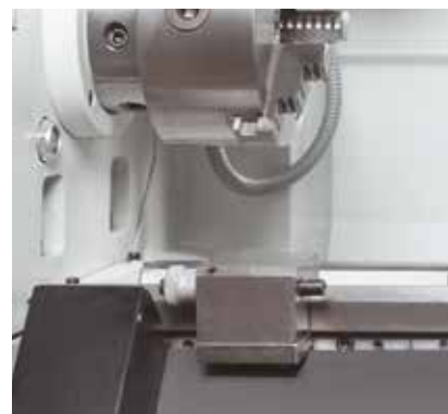
El tope de micrómetro de la plataforma asegura repetibilidad
