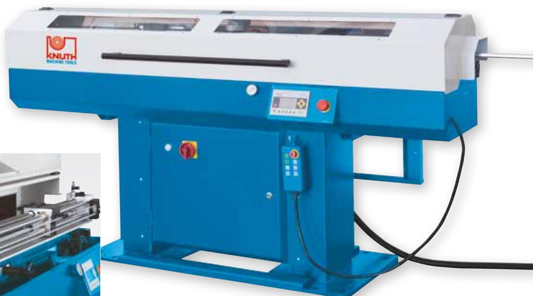
Procesamiento flexible de las varillas con diámetros de hasta 65 mm
