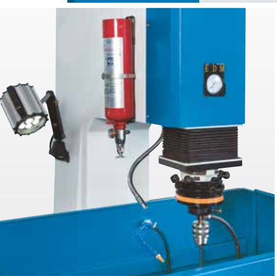
Sistema de extinción de incendios para mayor seguridad
