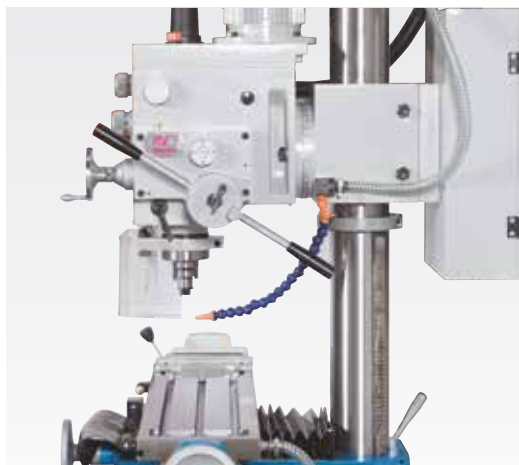
Eje hueco alimentación automática con engranajes de 3 pasos
