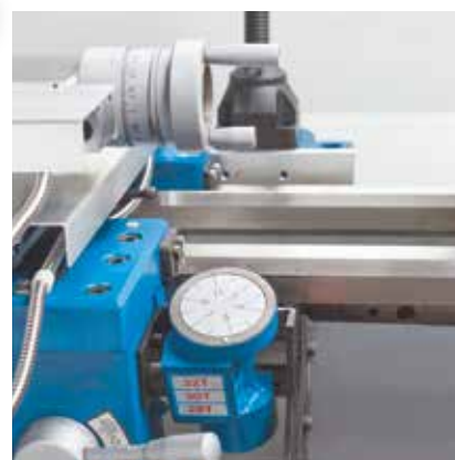
El calibrador de roscas permite reanudar la rosca después de que la tuerca de la placa frontal se ha abierto
