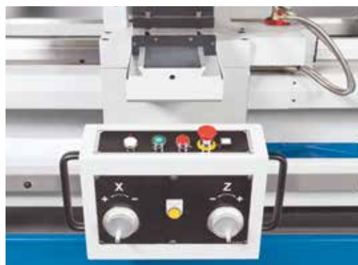
Unidad de control compacta con ruedas manuales electrónicas
