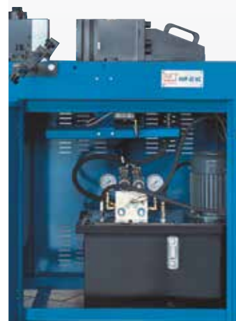
Unidad hidráulica compacta ubicada de manera accesible dentro de la base
