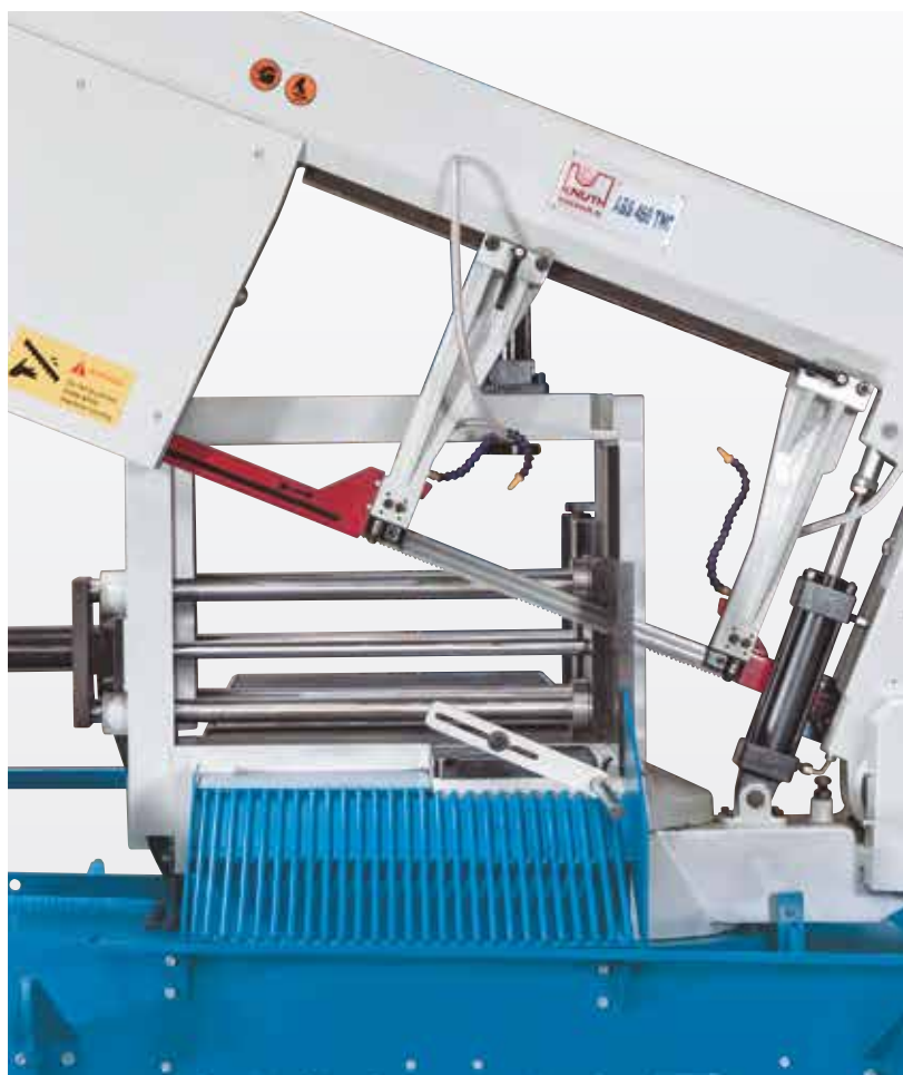
Los tornillos de banco de grúa doble hidráulico aseguran una máxima estabilidad, incluso durante el maquinado de paquetes
