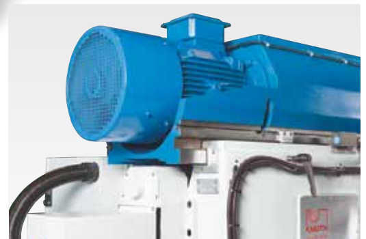
Accionamiento giratorio potente con caja de cambios auxiliar (Servomill® UWF 12)
