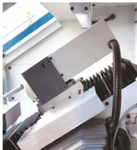
El diseño de plataforma inclinada optimiza el espacio de trabajo y la eliminación de lascas
