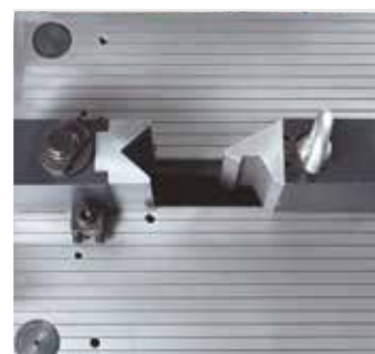
Deslizaderas de matriz de doblado largas, de apoyo y endurecidas con sistema de lubricación central
