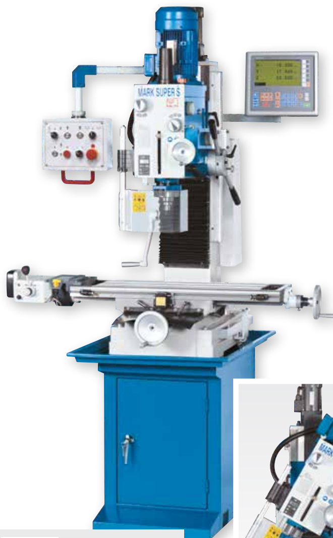
El cabezal gira \pm 45^\circ
