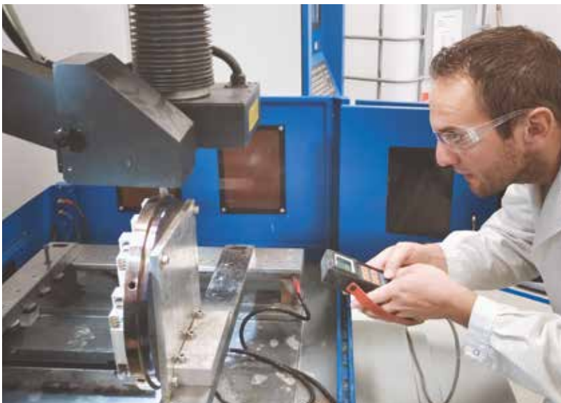
La geometría de la pieza se programa mediante la función Teach-In para garantizar una división perfecta. Aquí se muestra una plataforma de construcción mecanizada con componentes de acero inoxidable.
