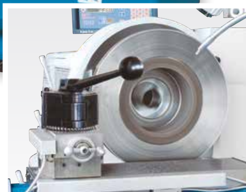
Turnado V: Velocidad de corte constante para superficies sin defectos
