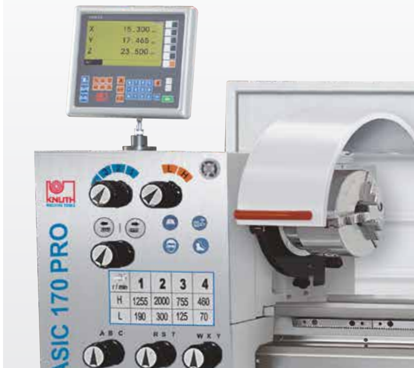
Indicador de posicionamiento del eje X, Y y Z1
