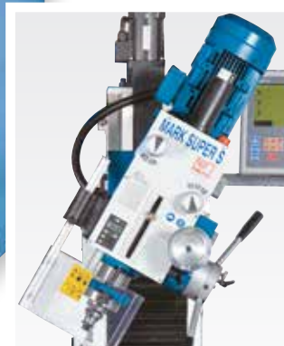
El cabezal gira \pm 45^\circ
