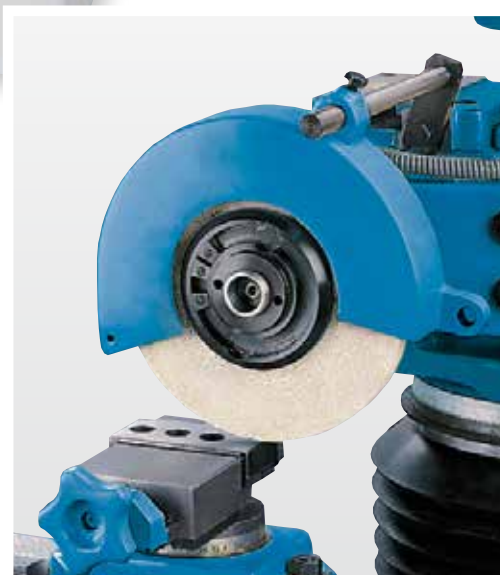
Rectificado de superficie con tornillo de banco de ángulo ajustable
