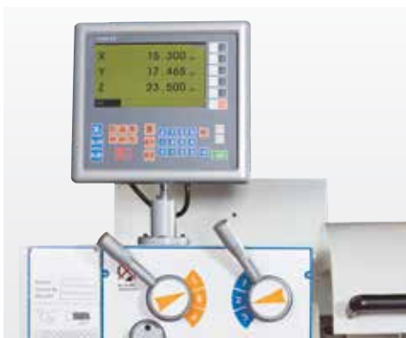
Positionsanzeige für X-, Z- und Z1-Achse
