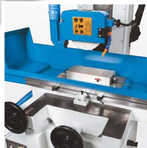
Permanent-Magnetspannplatte mit feiner Polteilung - ideal für präzise Schleifbearbeitung
