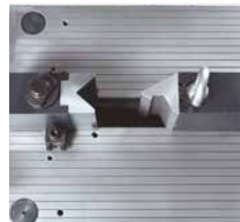
Der Biegestempel verfährt in lang abstützenden, gehärteten Führungen, die per Zentralschmierungseinheit mit Öl versorgt werden
