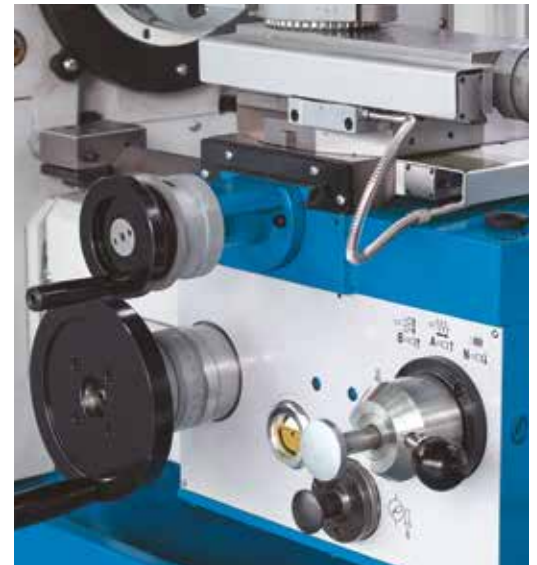
Wartungsfreundlichkeit und einfache Handhabung gewährleistet die im Support integrierte Zentralschmierung
