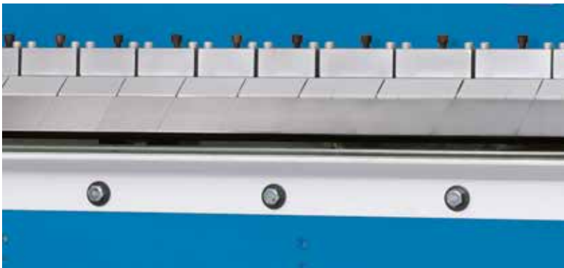
Serienmäßiges Oberwerkzeug mit Segmentteilen von 76, 102, 127 und 152 mm
