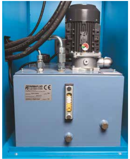
Das Hydrauliksystem ist platzsparend aber gut zugänglich im Gestell eingebaut
