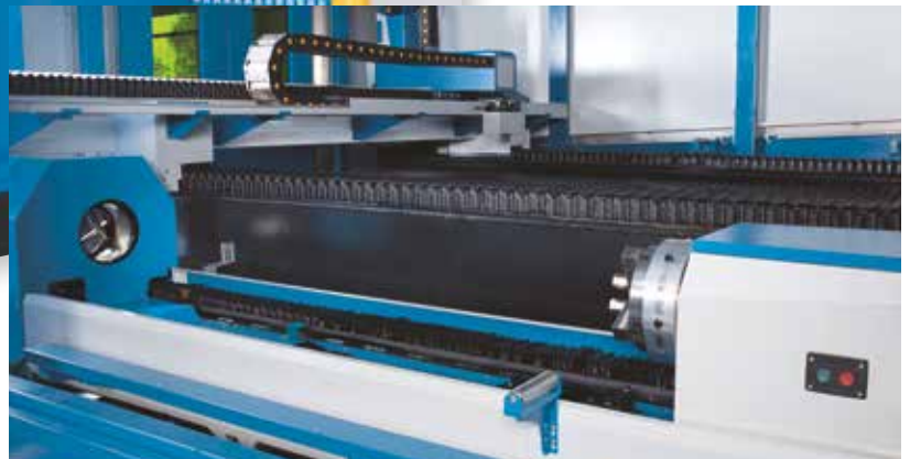
Option: Rohrschneideinrichtung bis 100 mm Durchmesser und 3 m Rohrlänge
