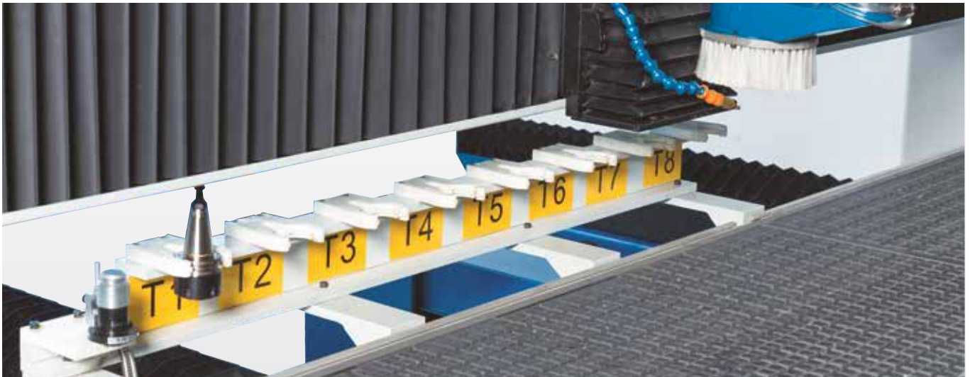
Linearer 8-fach Werkzeugwechsler
