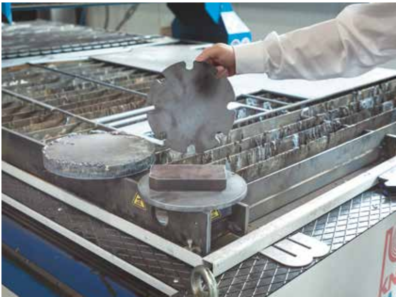
Qualitätssprung: Das linke Bauteil wurde noch vor dem Kauf mit einer Handplasmaanlage geschnitten. Mittig das präzise, mit der KNUTH Plasma-Jet geschnittene Bauteil.
