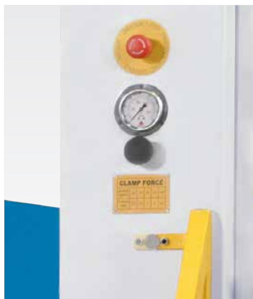
Regelbarer Klemmdruck der Oberwange
