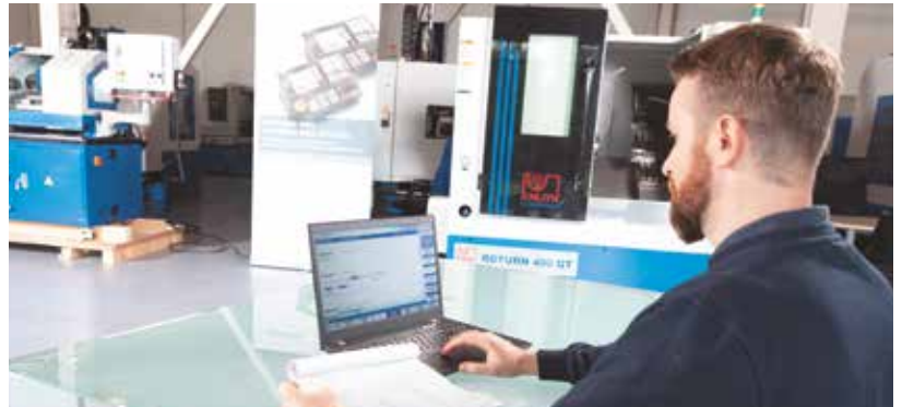
KNUTH-Servicetechniker kann sich über eine sichere VPN-Verbindung auf die Steuerung der Kundenmaschine schalten
