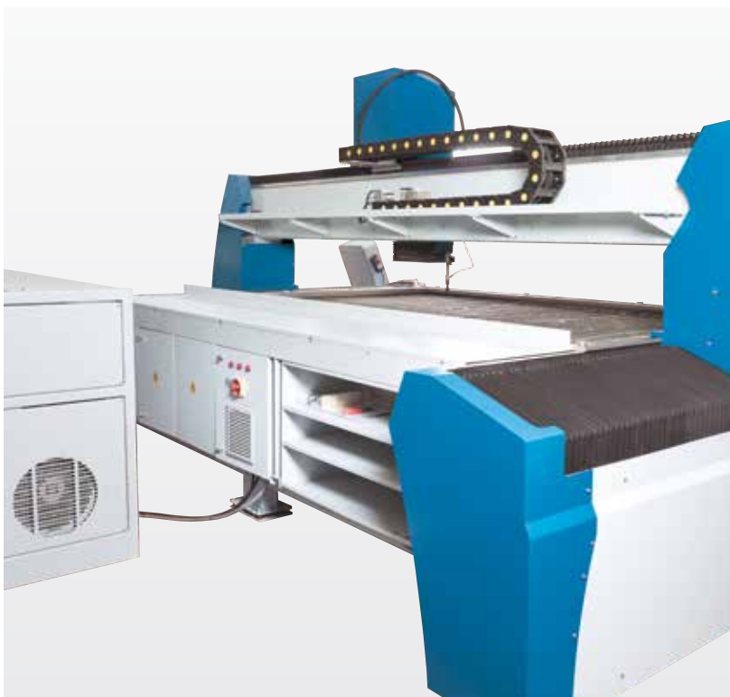
Gegen Wasser und Staub vollständig gekapselte Bewegungseinheiten
