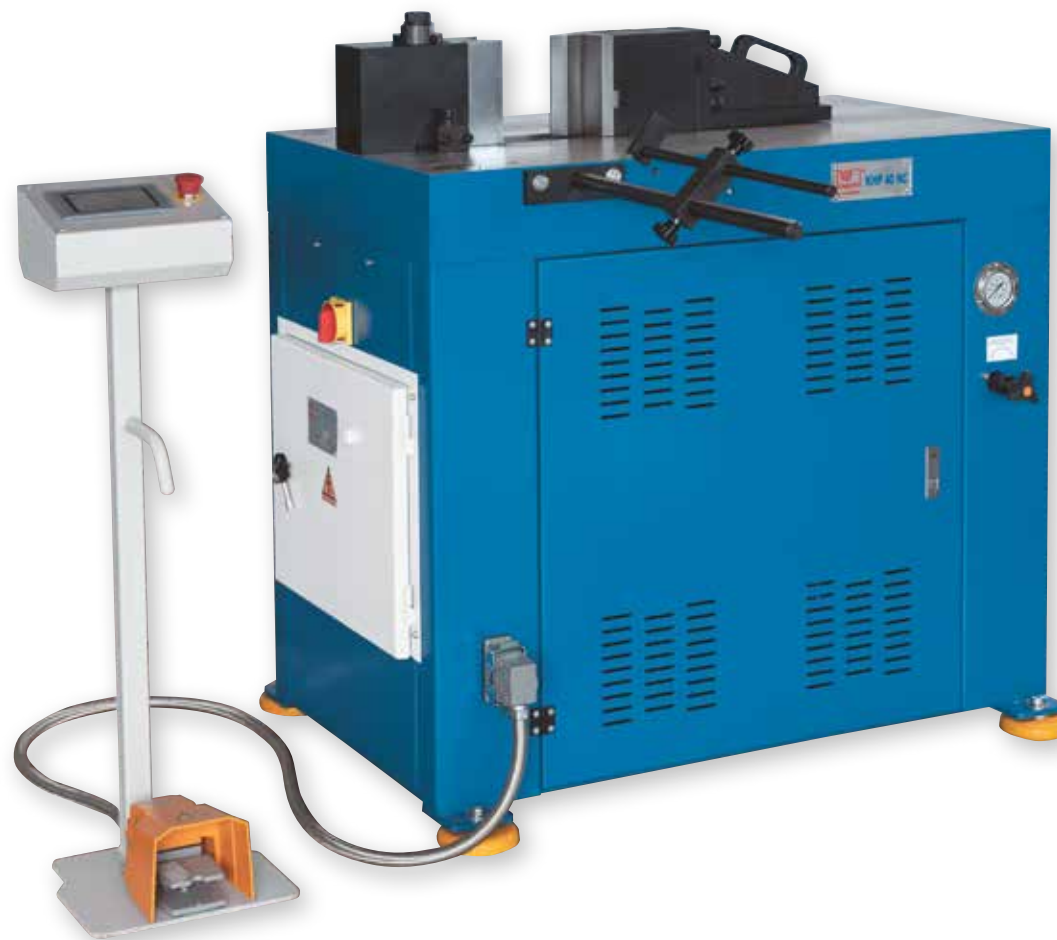
Die kompakte Hydraulikeinheit sitzt gut zugänglich im Untergestell
