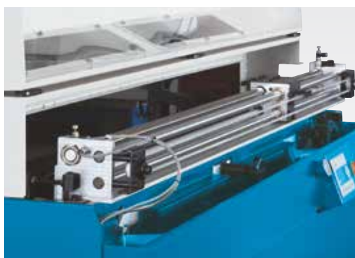
Flexible Verarbeitung von Materialstangen bis 65 mm Durchmesser
