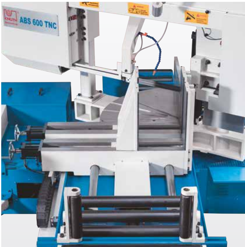
Manuelle Winkelverstellung des Sägebügels mit hydraulischem Antrieb ( 15°, 30° und 45°)
