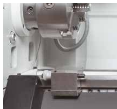
Der Mikrometer-Bettanschlag garantiert Wiederholgenauigkeit
