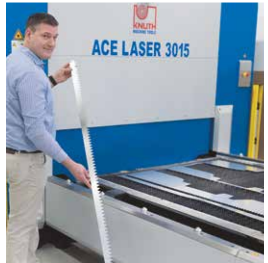
Das automatische Wechseltischsystem minimiert die Fertigungsnebenzeiten.
