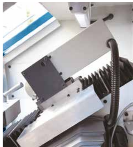
Schrägbettbauweise für optimierten Arbeitsraum und Späneabfuhr
