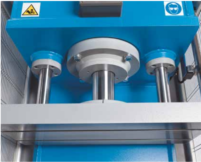
Zwei Rundführungen gewährleisten die Parallelität der Stößelplatte während der Hubbewegung
