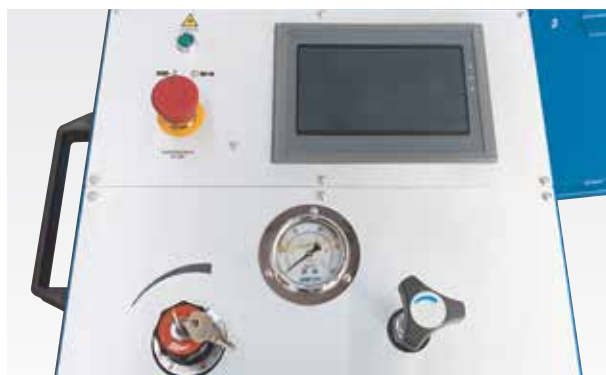
PLC- Steuerung mit Grafik-Touchscreen
