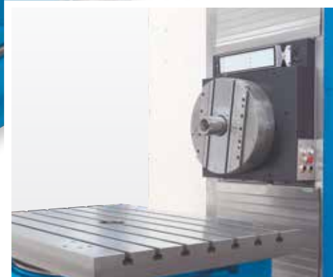
Spanntisch mit manueller Winkeljustierung
