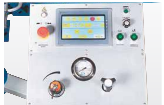
Bedienfeld mit Grafik- Touchscreen Display der Steuerung
