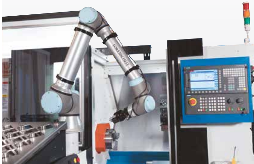
6-achsiger Roboterarm mit einem Arbeitsradius von 1300 mm
