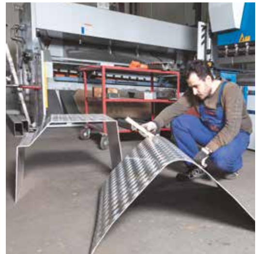
Fast fertiges Bauteil mit Radius, Schutzabdeckung für den Kraftstofftank eines Langholz-LKWs
