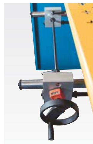
Manueller Hinteranschlag mit mechanisch-digitaler Positionsanzeige
