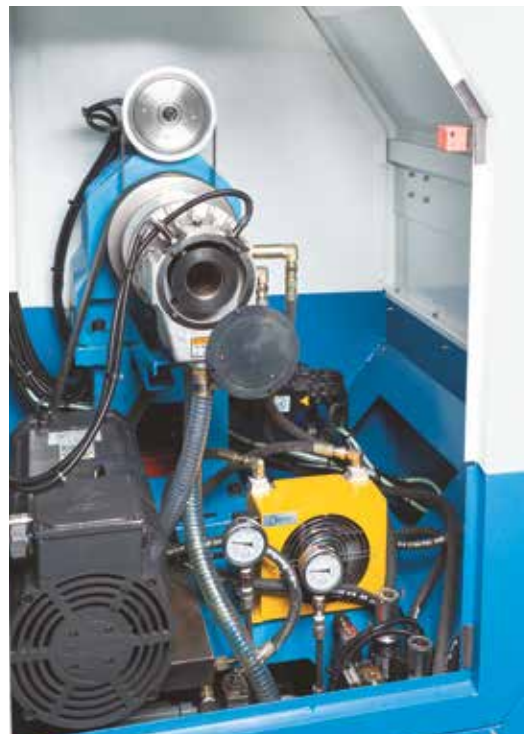
Die Spindelbohrung im Zugrohr beträgt 48 mm
