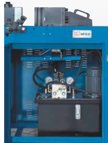
Die kompakte Hydraulikeinheit sitzt gut zugänglich im Untergestell
