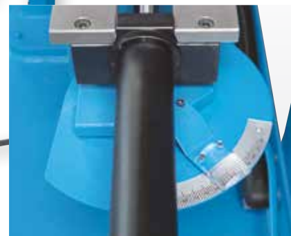
Der Schnittwinkel ist präzise einstellbar und kann exakt abgelesen werden
