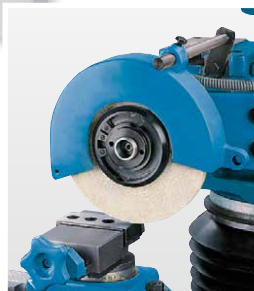
Flachscheifen mit winkelverstellbarem Schraubstock
