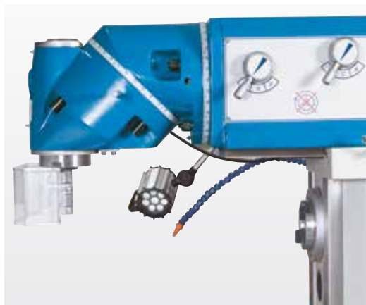
In 2 Ebenen schwenkbarer Universalfräskopf
