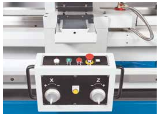
Kompakte Bedieneinheit mit elektronischen Handrädern
