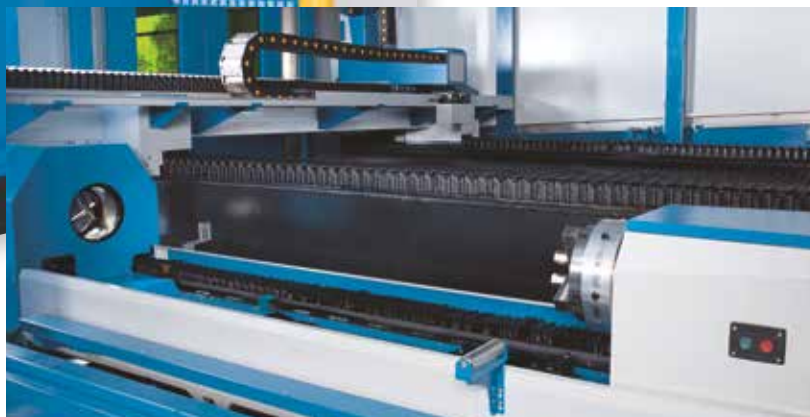
Mimořádná výbava : zařízení na řezání trubek s průměrem do 100 mm a délkou 3 m
