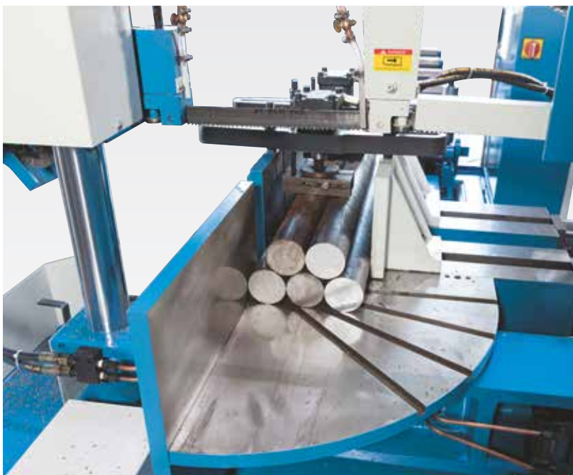
Hydraulické zařízení pro upínání svazků pro oba svěráky sériově
