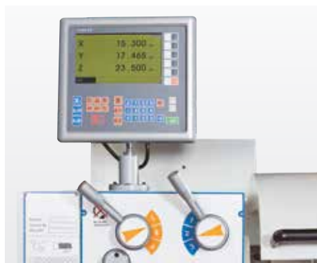
Zobrazení polohy pro osu X, Z a Z1
