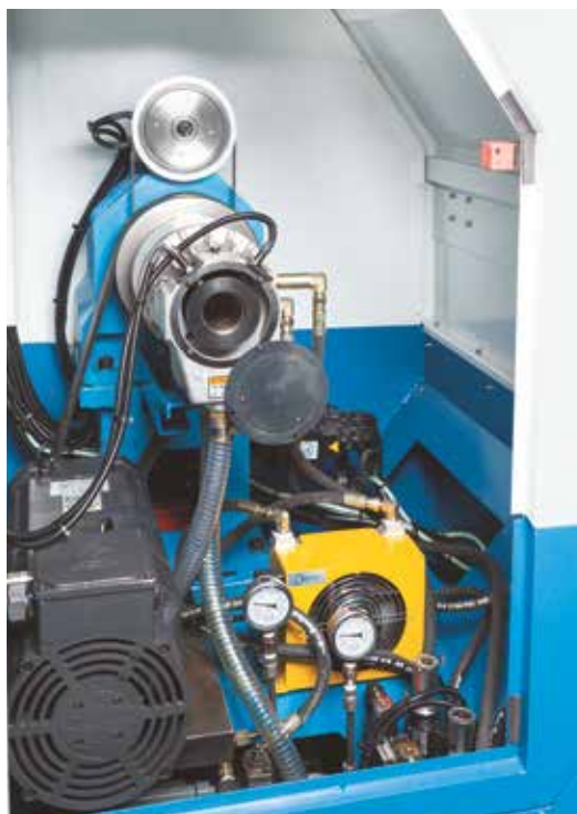
Otvor vřetena v tažné trubce má velikost 48 mm
