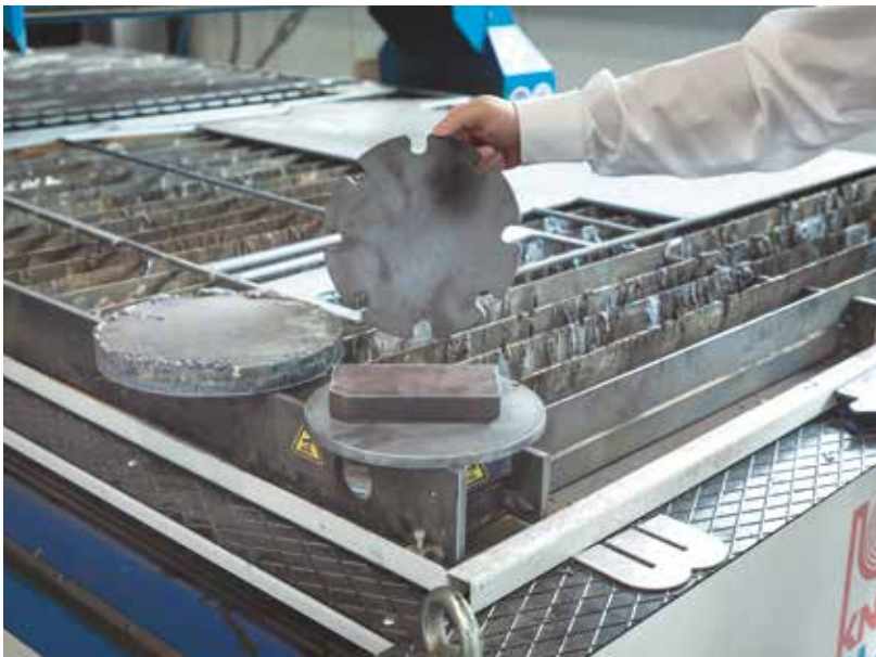
Skok v oblasti kvality: Levý konstrukční díl byl nařezán ještě před nákupem manuálního plazmového zařízení. Uprostřed přesný konstrukční díl řezaný strojem KNUTH Plasma Jet.
