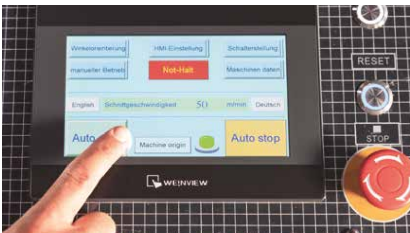
V automatickém režimu lze naprogramovat délku posuvu, úhel řezu a počet řezů v příslušné konfiguraci
