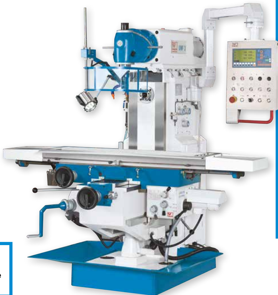
Stabilní podpěrné rameno pro dlouhé frézovací trny
