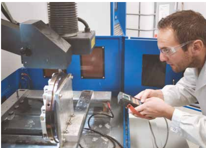
Pro perfektní oddělení se zaučuje geometrie obrobku. Zde byla zpracována stavební deska s díly z ušlechtilé oceli.
