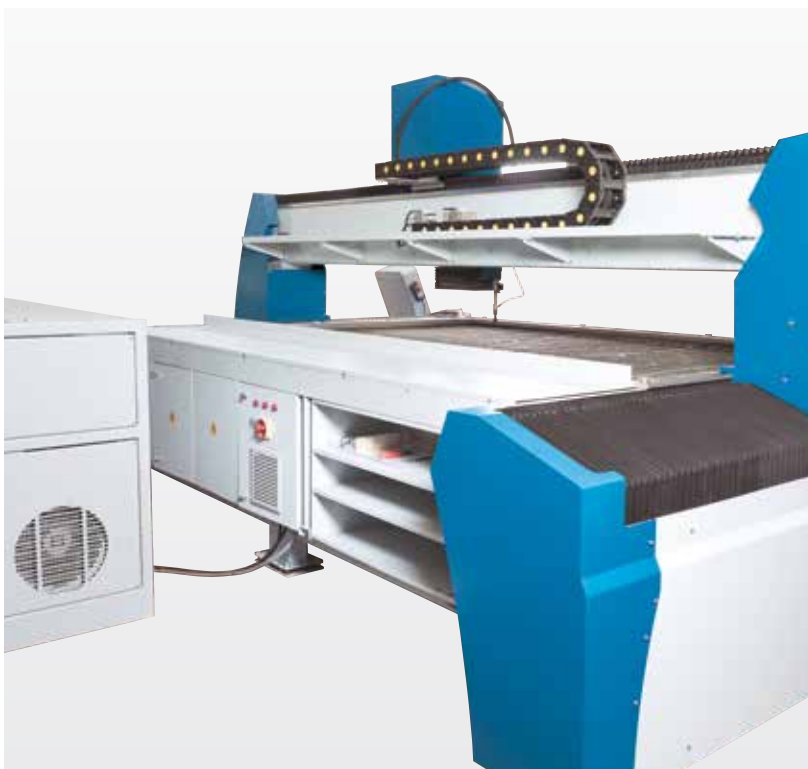
Pohyblivé jednotky zcela zapouzdřené proti vodě a prachu
