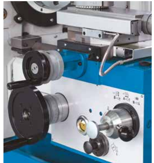
Snadnou údržbu a jednoduchou manipulaci zaručuje centrální mazání integrované v suportu
