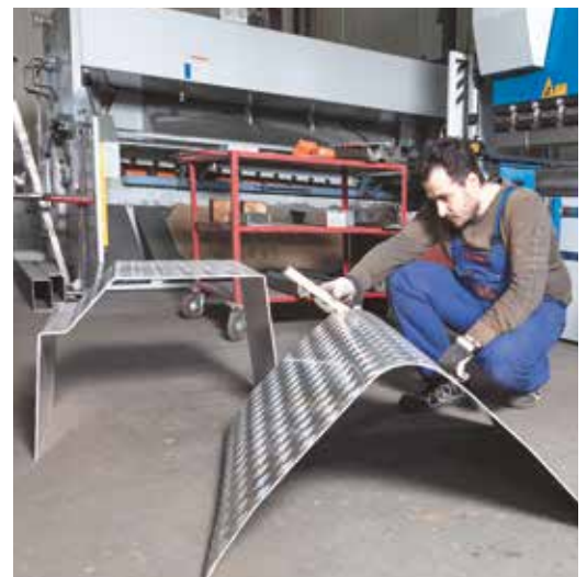
Téměř hotový díl s poloměrem, ochranný kryt pro palivovou nádrž nákladního vozidla pro dlouhé dřevo
