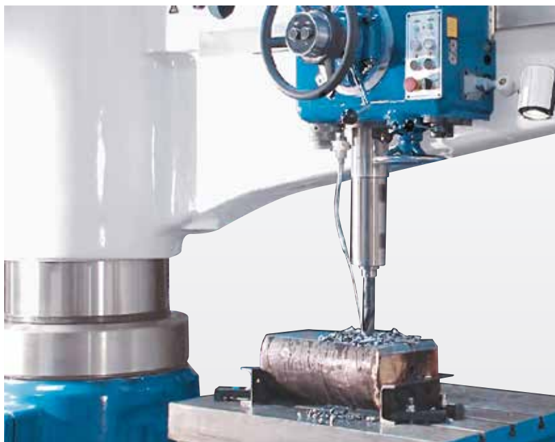
Výkonné obrábění při automatickém posuvu
