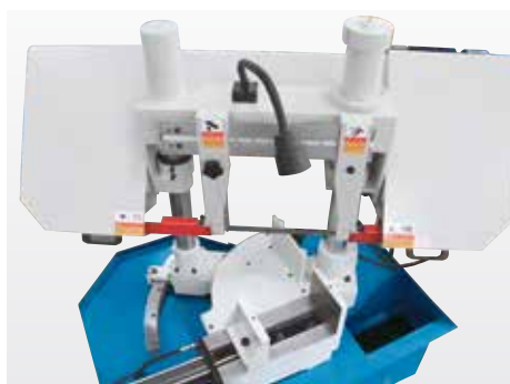
Otočný třmen pily vedený dvojicí sloupů
