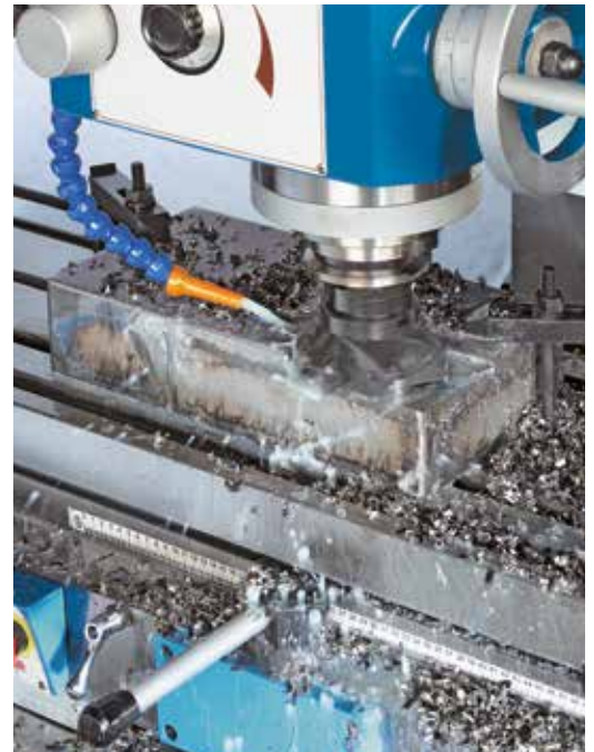
Rovinné frézování nožovou hlavou
