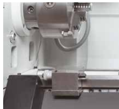
Doraz s jemným mikrometrovým nastavením zaručuje přesnost při opakování
