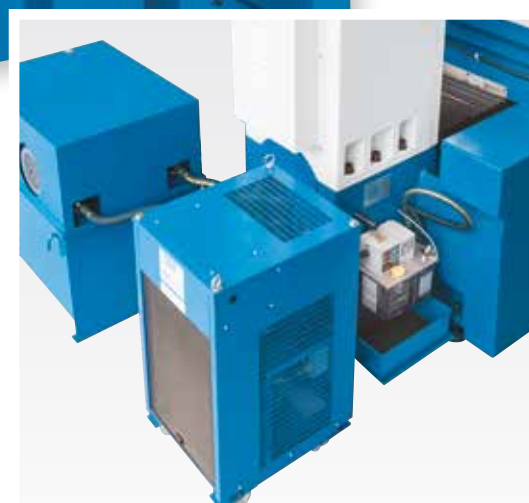
Externí hydraulický agregát a chladič oleje pro stabilitu teploty v trvalém provozu
