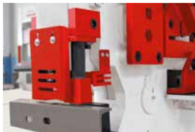
Vysmekovací stanice s ochranným zařízením
