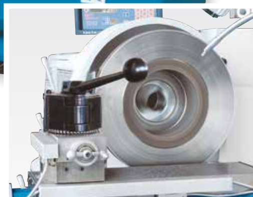
Turnado V: Konstantní řezná rychlost pro perfektní povrch
