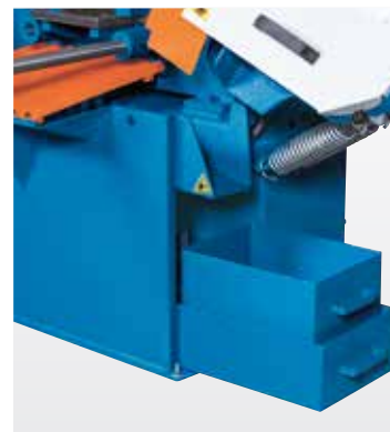
Lehce přístupná nádrž s chladicím prostředkem s velkým filtrem na třísky
