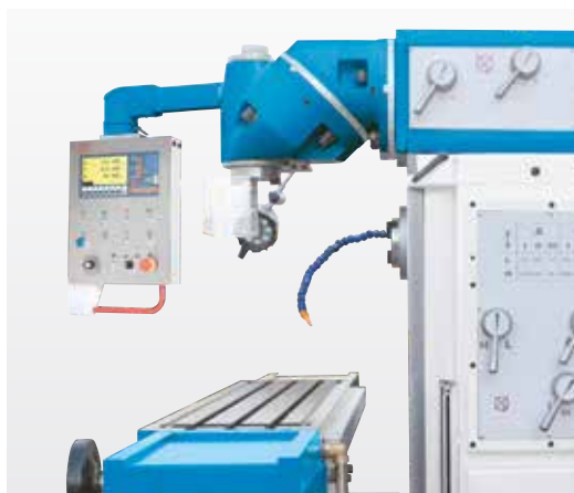
Velký pracovní prostor a frézovací hlava výkyvná ve 2 rovinách
