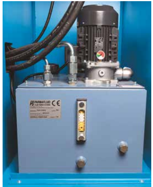
Hydraulický systém je prostorově nenáročný, avšak s dobrým přístupem zabudovaný v podstavci
