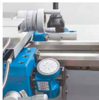
Číselníkový úchylkoměr na závity zajišťuje opětovné uchycení otočky závitu po vytočení svorkové matice pro zpětný pohyb
