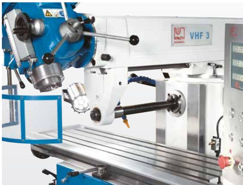
Горизонтальный фрезерный шпиндель с серьгой для длинных фрезерных оправок
