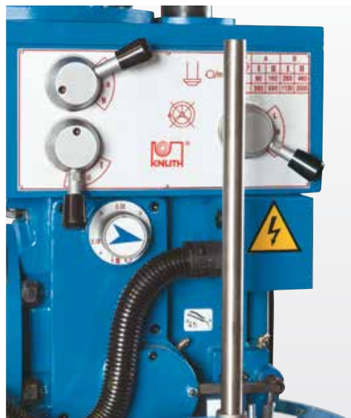
Automatický posuv pinoly se 3 stupni
