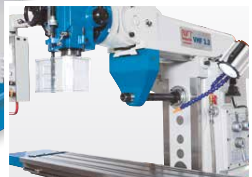
Lange Fräsdorne werden vom soliden Gegenhalter geführt
