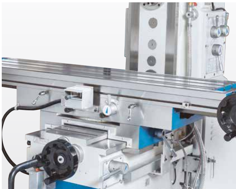
Frézovací stůl má velkou upínací plochu a může se otáčet v podélném směru
