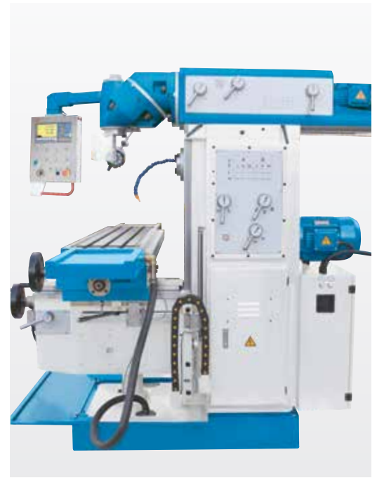
Gran área de trabajo, cabezal de corte giratorio en 2 niveles
