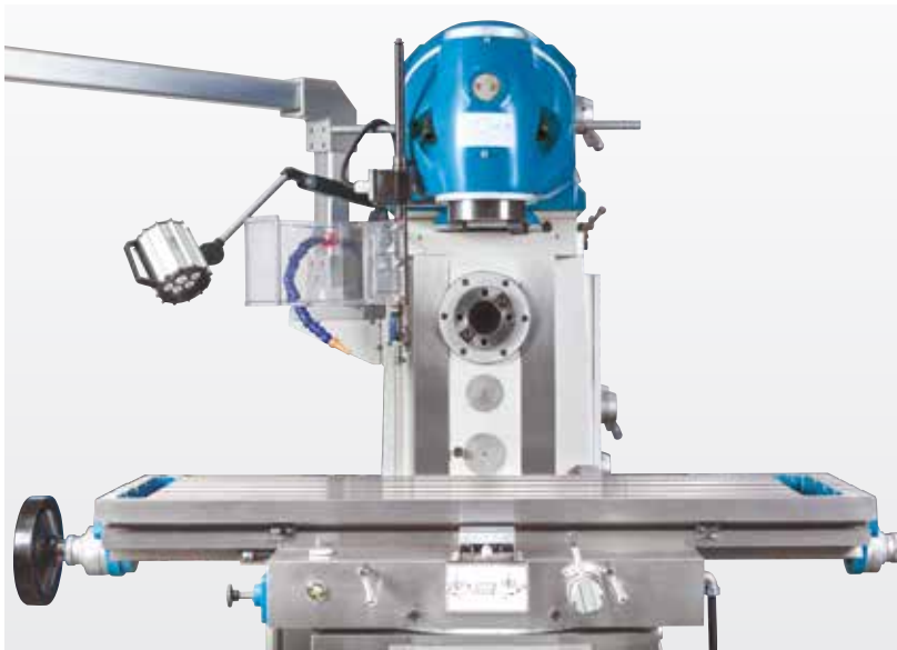
Mocne wrzeciono poziome z własnym napędem
