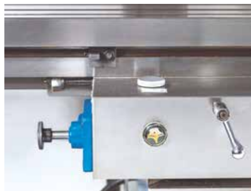
Lubrification centralisée manuelle intégrée
