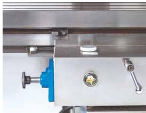
Integrierte manuelle Zentralschmierung
