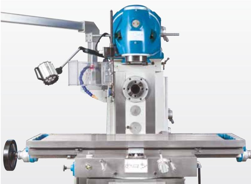
Kraftvolle Horizontalspindel mit eigenem Antrieb
