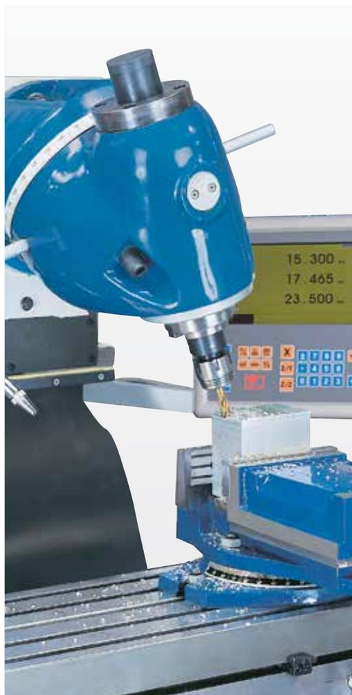
Фрезерная головка может поворачиваться в 2 плоскостях
