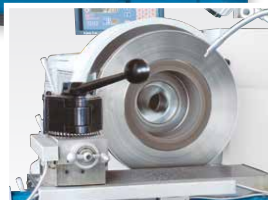
Turnado V: Постоянная скорость резки для получения идеальной поверхности
