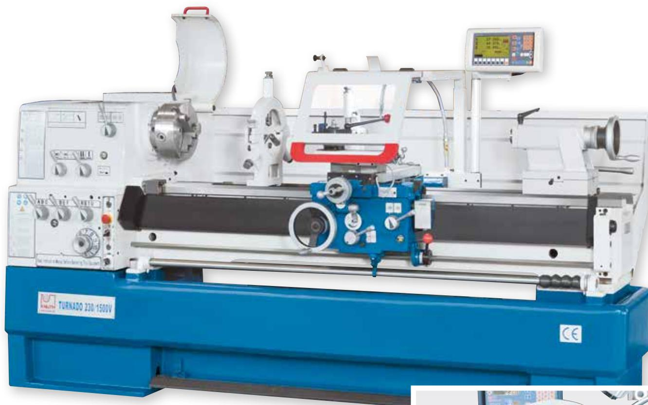
In fig. Turnado 230/1500 V con indicatore di posizione su 3 assi e velocità a variazione continua
