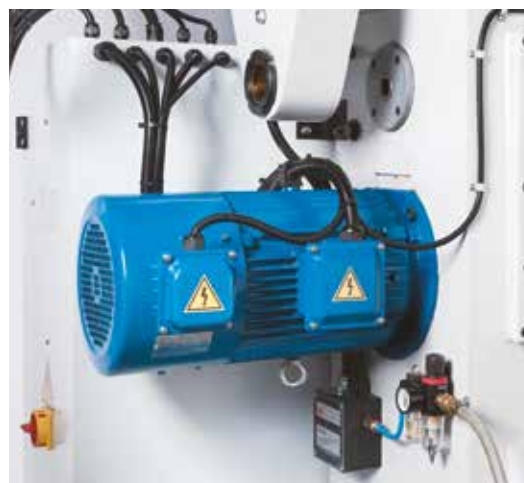
Мощный привод горизонтального шпинделя
