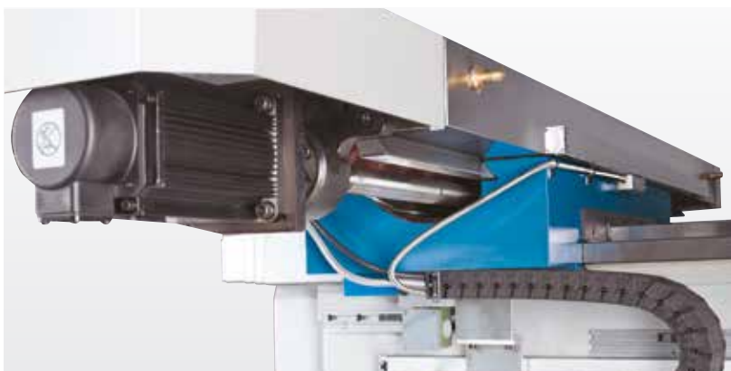
Elevata precisione grazie alle viti a ricircolo di sfere
