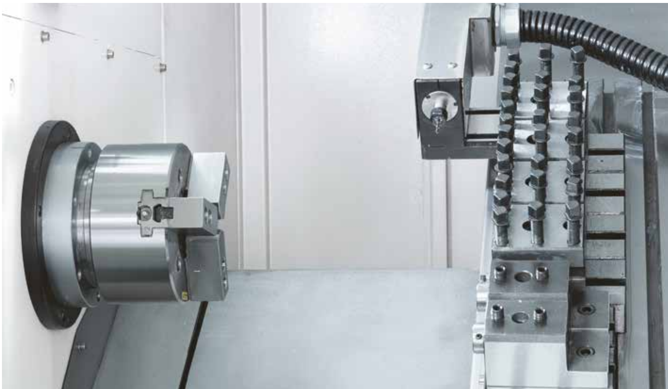
Liniowa zmieniarka narzędzi z narzędziem napędzanym
