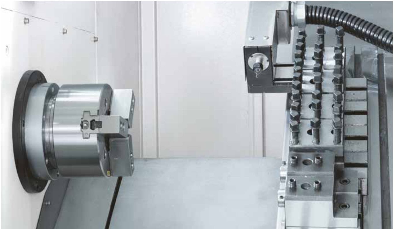
Cambiatensili lineare con utensile motorizzato
