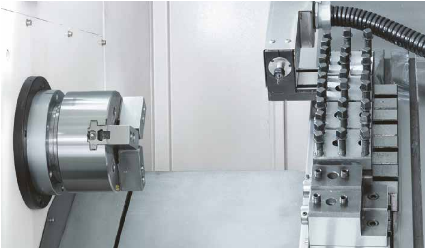
Changeur d'outils linéaire avec outils entraînés
