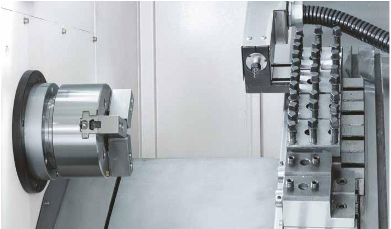
Linearer Werkzeugwechsler mit einem angetriebenen Werkzeug
