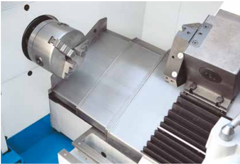
Устойчивая облицовка направляющих из нержавеющей стали
