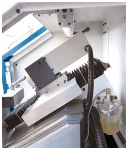
Construcție pat oblic pentru un spațiu de lucru optimizat și pentru evacuarea șpanului
