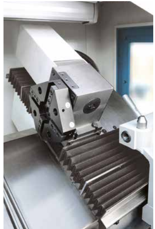
8-pozycyjny rewolwer narzędziowy z 4 narzędziami do obróbki wewnętrznej i zewnętrznej
