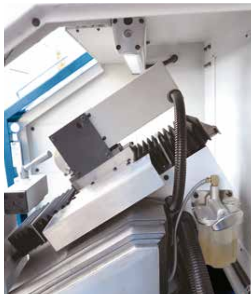
Struttura a bancale inclinato per ottimizzare l'area di lavoro e la rimozione dei trucioli
