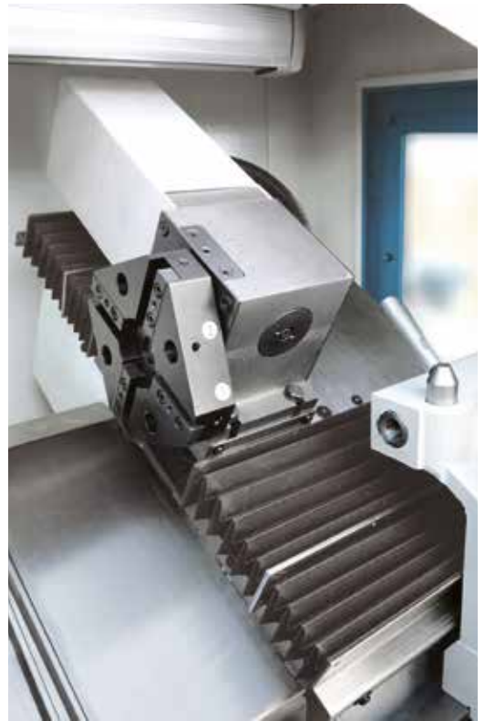
Torreta de herramientas de 8 estaciones con 4 herramientas por estación para girado interior y exterior
