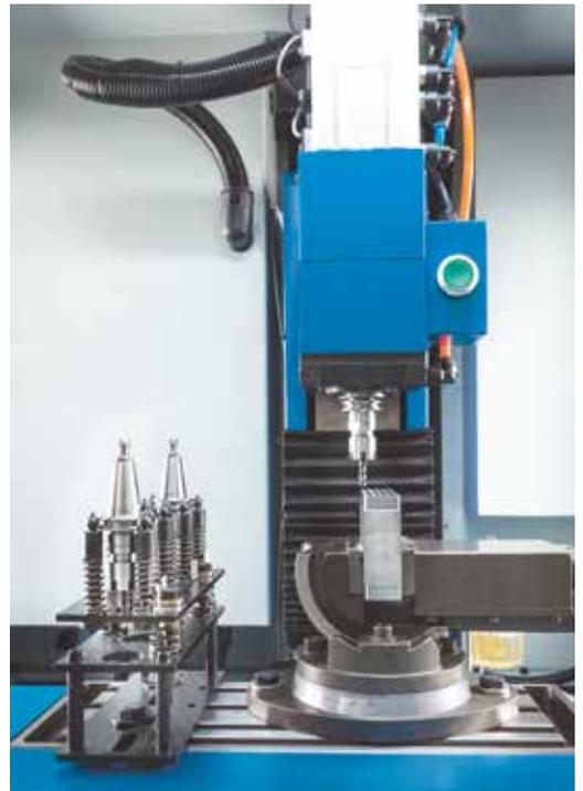
4-секционный механизм смены инструмента
