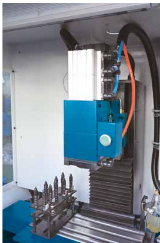
Serrage d'outil pneumatique
