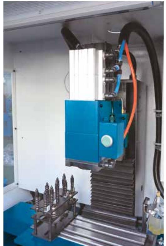
Sujeción neumática de la herramienta
