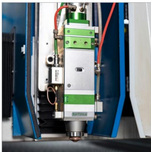
° Der hochwertige Schneidkopf der Schweizer Marke RayTools bietet einen integrierten Motor mit linearem Antrieb für die präzise motorgesteuerte Positionierung.
