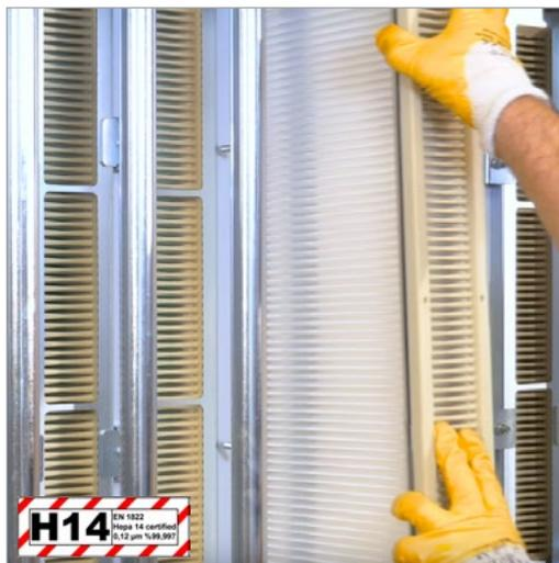
° Die PL-Serie ist mit äußerst hochwertigen Filtereinheiten mit der W3 Dedusting-Klassifizierung (beste Filtrationsleistung nach dem Stand der Technik) ausgestattet.
