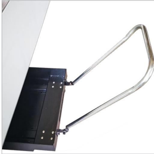
° Die Maschine ist standardmäßig mit seitlichen Abfallschubfächern ausgestattet, in denen Kleinteile und Abfallmaterial ohne Unterbrechung des Schneidprozesses entfernt werden können.
