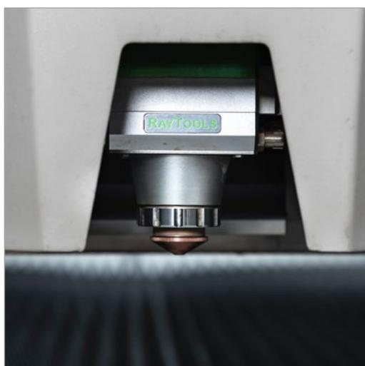
° Der zur Standardausstattung gehörende Kollisionssensor schützt den Kopf vor Kollisionen mit den Schneidteilen oder dem Werkstück.
