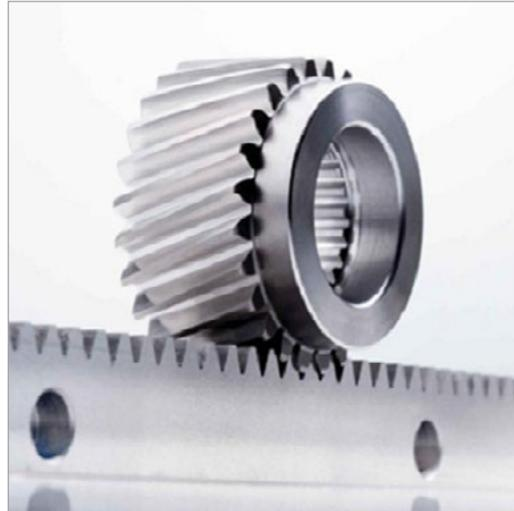
° Die Kraftübertragung in der X- und Y-Achse erfolgt über hochwertige schrägverzahnte Zahnstangengetriebe des taiwanesischen Herstellers KAI HE oder YYC. Infolge eines höheren Überdeckungsgrads (Anzahl der effektiv ineinandergreifenden Zähne) kann dieses verschleiß- und wartungsarme Antriebssystem problemlos hohe Lasten und anspruchsvolle Arbeitszyklen handhaben.
