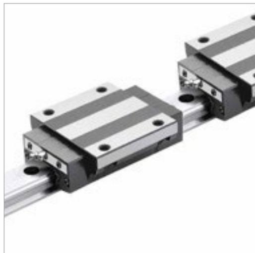
° Die speziellen Linearführungen von CSK oder PMI in allen Achsen zeichnen sich durch hohe Stabilität aus. Die Belastungen sind in der radialen, gegenradialen und lateralen Richtung gleich und selbstausrichtend, um Installationsfehler abzufangen. Sie sind für eine lange Lebensdauer und ruckarme lineare Bewegungen bei hohen Geschwindigkeiten ausgelegt.
