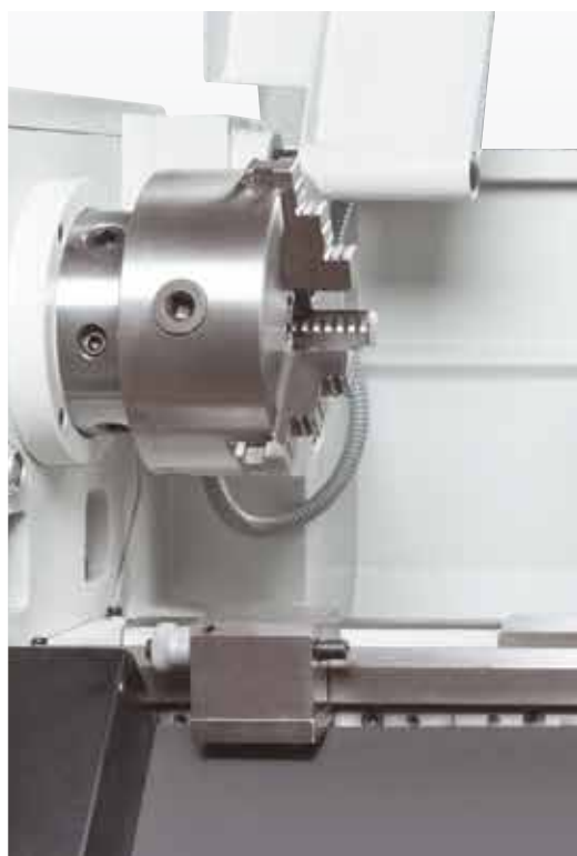
Dokładny zderzak zapewnia wysoką powtarzalność
