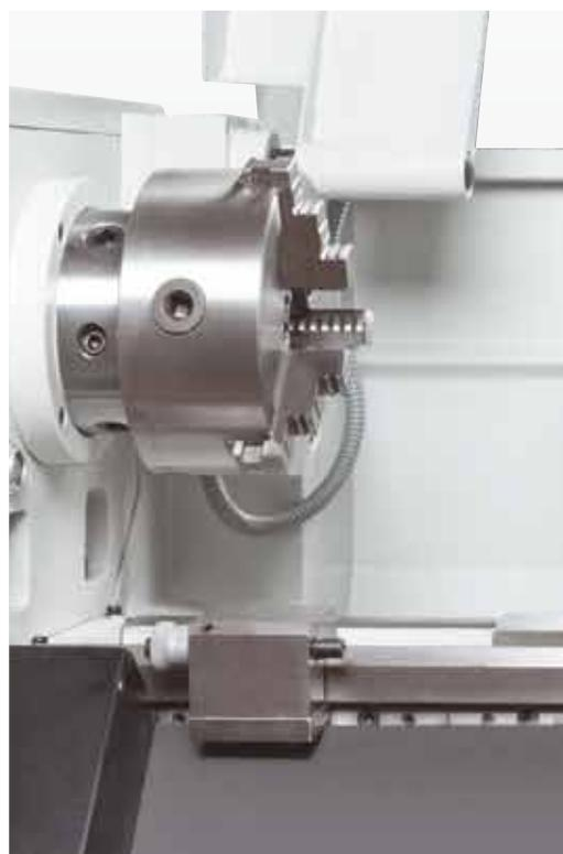
L'arresto micrometrico sul bancale garantisce la precisione di ripetibilità
