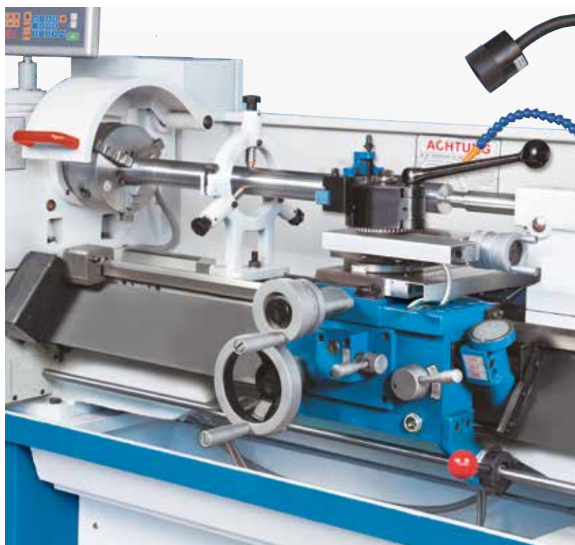
Les pièces longues sont soutenues dans des lunettes stables
