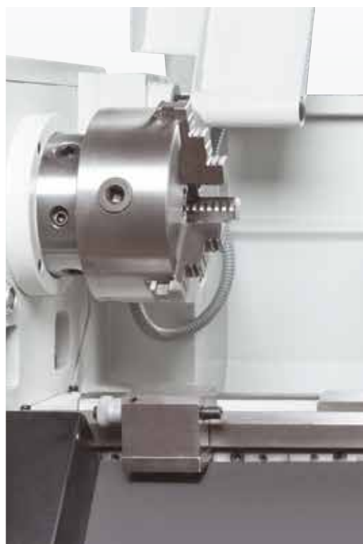
La butée de banc micrométrique garantit la précision de répétabilité
