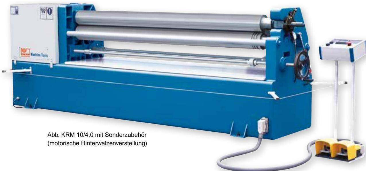
Abb. KRM 10/4,0 mit Sonderzubehör (motorische Hinterwalzenverstellung)
