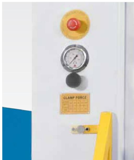
Presión de sujeción del troquel superior ajustable
