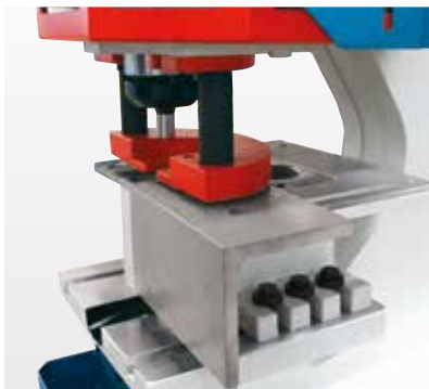
Stație de poansonare cu masă de susținere mare
