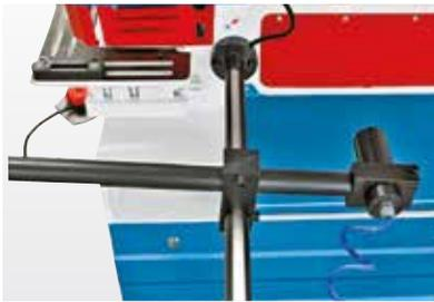
Hinteranschlag mit automatischer Schnittausslösung
