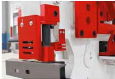
Auslinkstation mit Schutzeinrichtung
