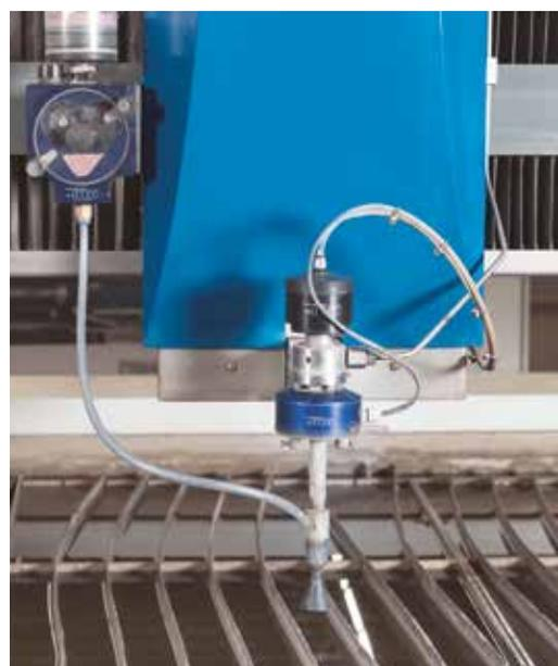
Режущая головка и абразивная система оптимально согласованы с соответствующей системой высокого давления. Насосы высокого давления BFT с режущей головкой ALLFI и абразивной системой (рис.)
