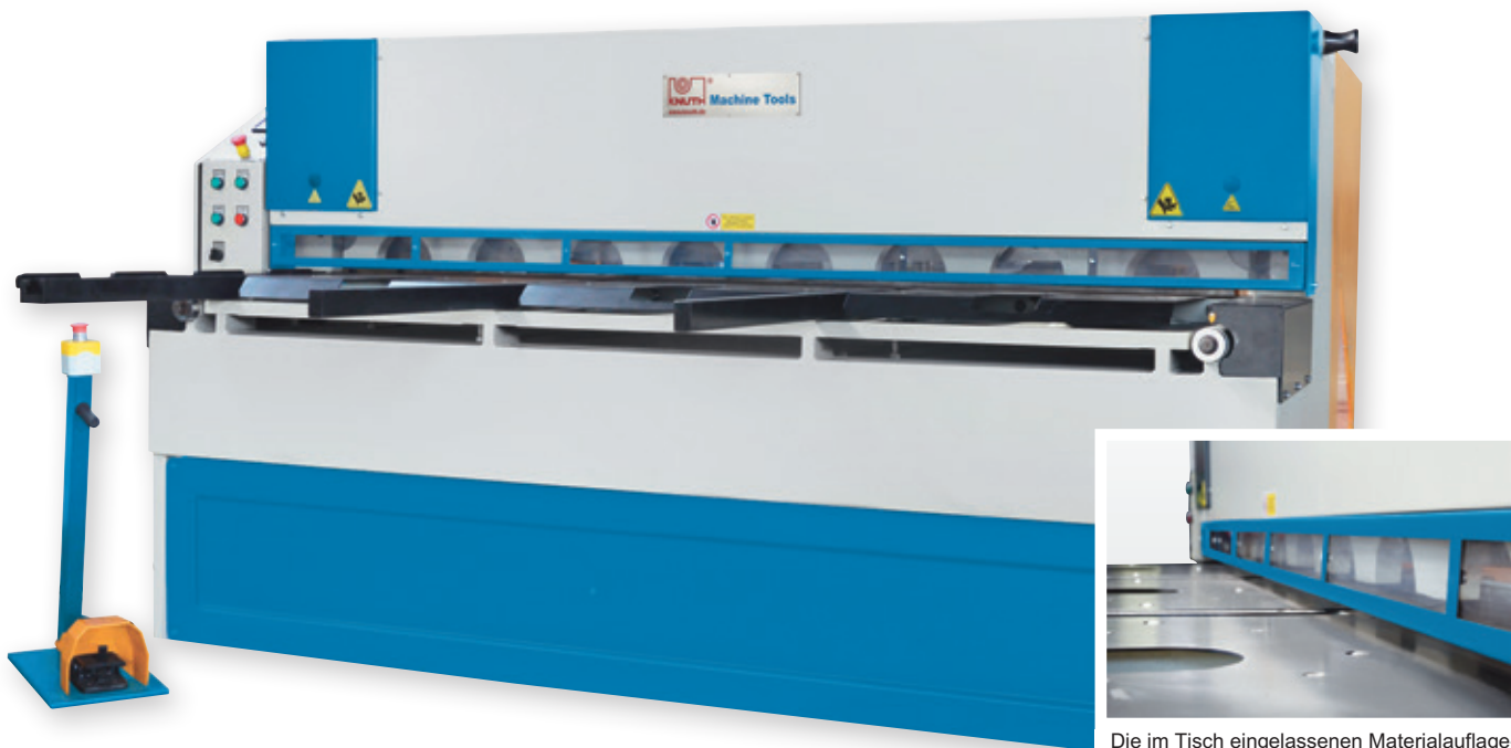
Die im Tisch eingelassenen Materialauflagekugeln erleichtern das Werkstückhandling
