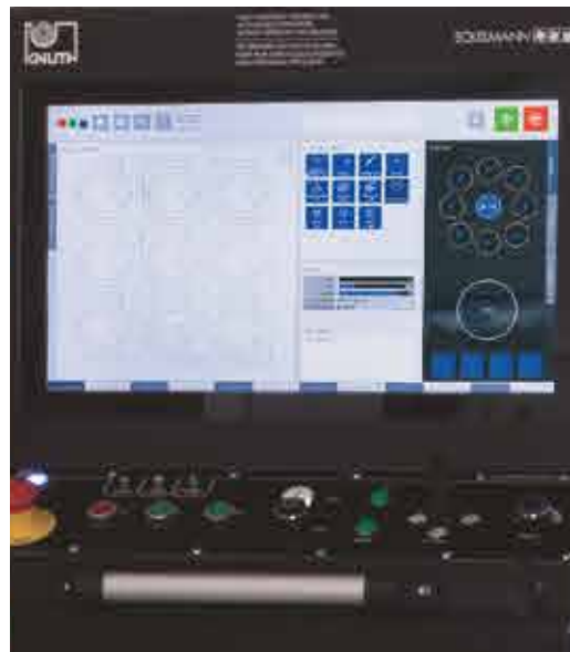
Eckelmann jednostka CNC z ekranem dotykowym 19" do modeli K TrueCut
