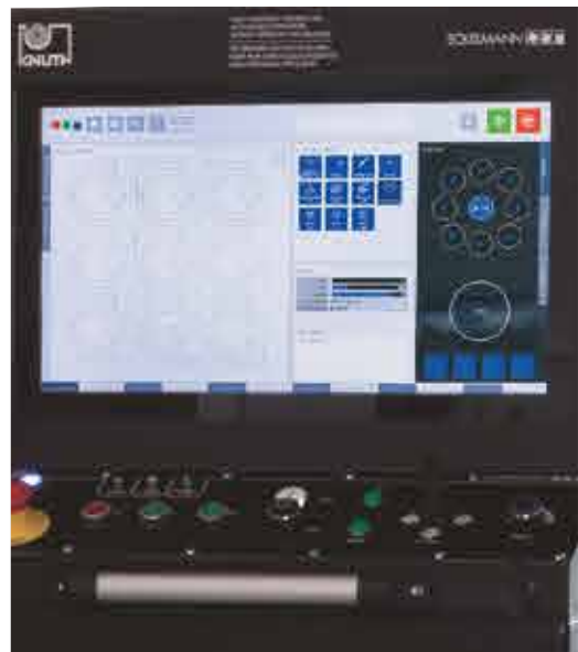
Eckelmann CNC-Einheit mit 19" Touchscreen für TrueCut K-Modelle
