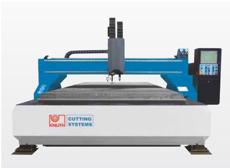
Obr. s přídatnou hlavou na řezání autogenem „Nůž“ (volitelné)
