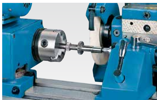
Rectificado exterior cilíndrico para longitud de hasta 400 mm
