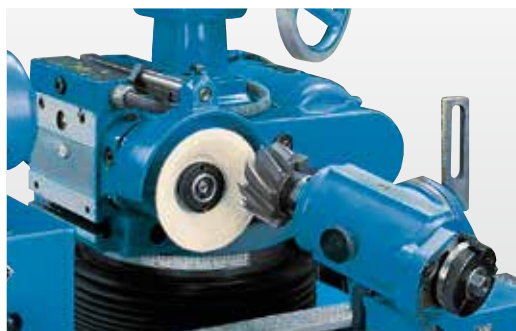
Stabile winkelbare Werkstückaufnahmen
