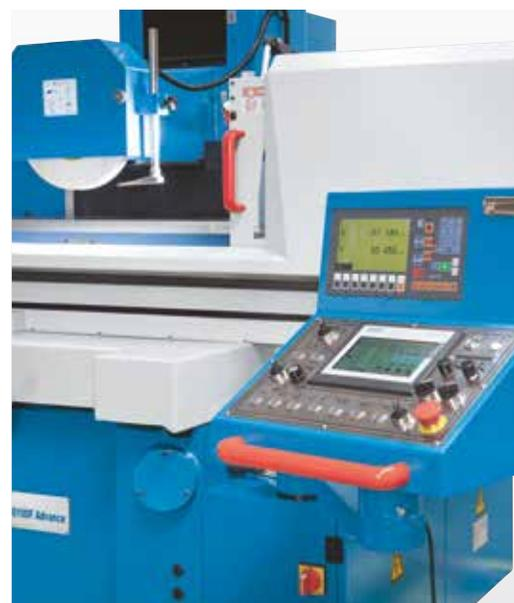
В автоматическом режиме обрабатываются определяемые оператором установки грубой и чистовой шлифовки, количество проходов и обратный ход в исходное положение
